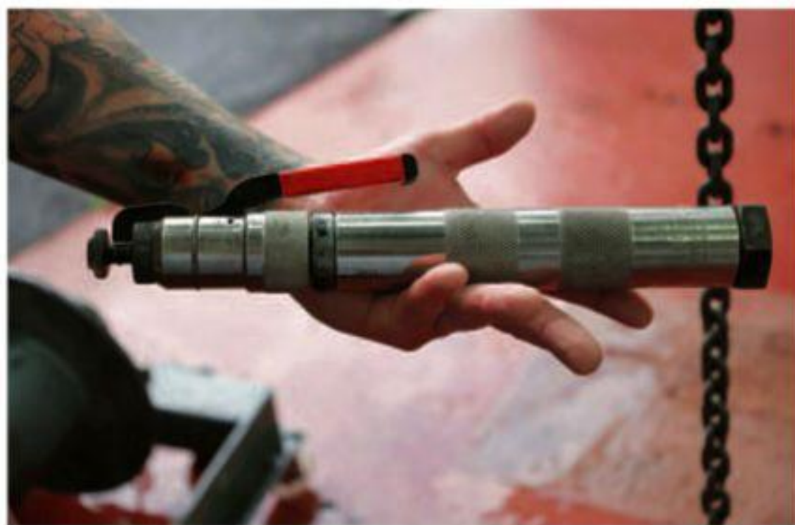
Der Bolzen des Bolzenschussgeräts dringt in das Hirn ein und tötet das Pferd sofort.
