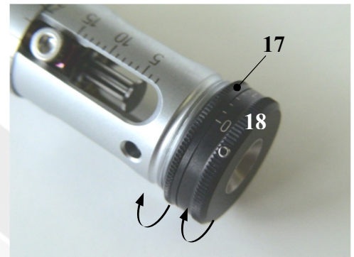
Bild 21. Mutter und Zentrierskala einschrauben
