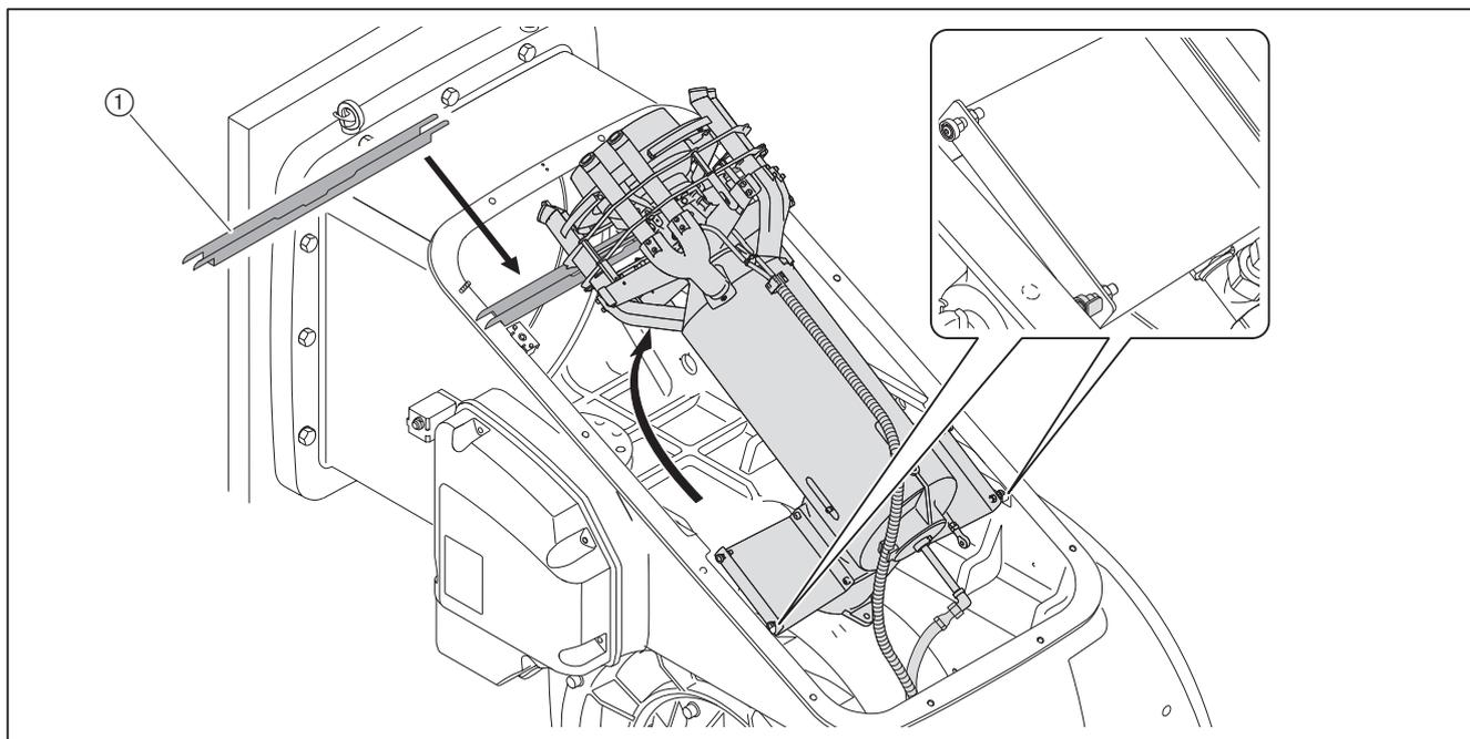
Если нужно полностью демонтировать смесительное устройство, необходимо стропу завести под смесительное устройство и поднять подъёмником (краном).
