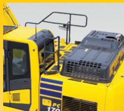
Ledstänger och halkskyddsplåt
