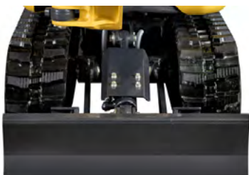
Indraget underrede 680 mm - enkel manövrering
