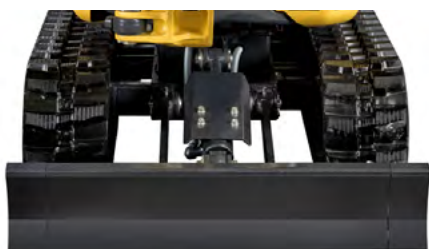
Utdraget underrede 840 mm - Ökad stabilitet
