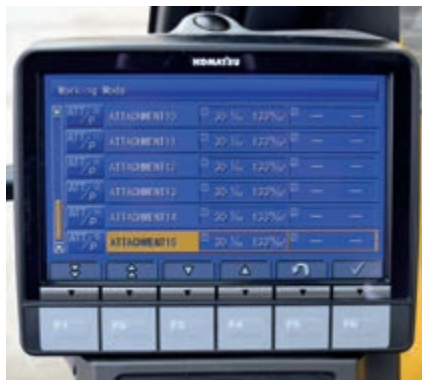
Integrerad redskapsstyrning (Komatsu Integrated Attachment Control, KIAC) för upp till 15 hydrauliska redskap för oljeflöde och tryck
