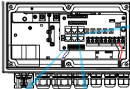
Para la conexión entre el inversor y la batería, el cable RJ45 se conectará al puerto CAN-1 de la batería.
