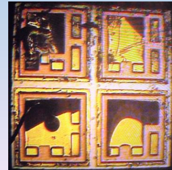
Cip D1 după testarea în temperatură până la 430°C
