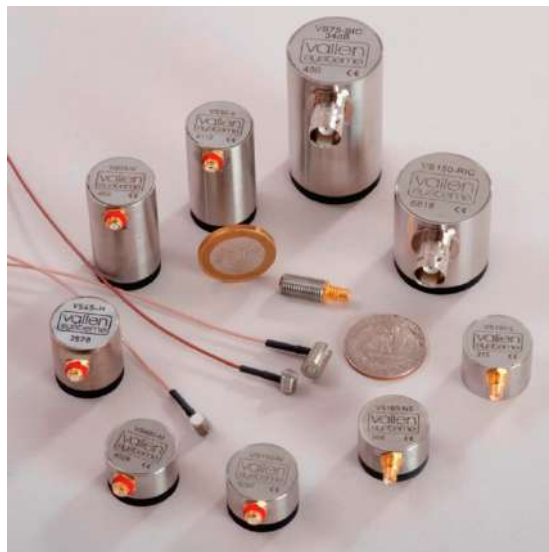
Figur 10-2 AE Sensorer med olika frekvens känslighet (Cai & Nair, 2010)
