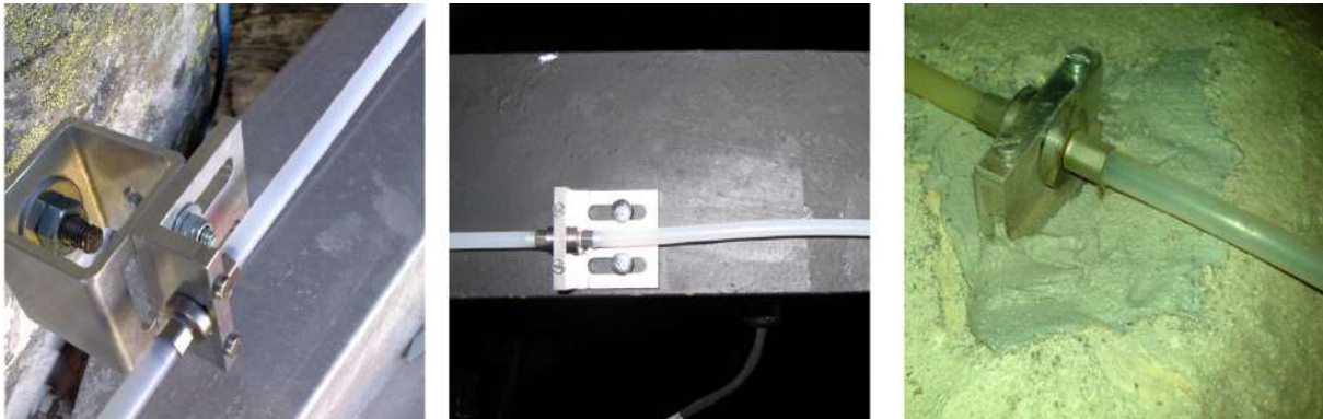
Figur 9-11 Exempel på infästning av SOFO-sensorn (SMARTEC, 2009)
