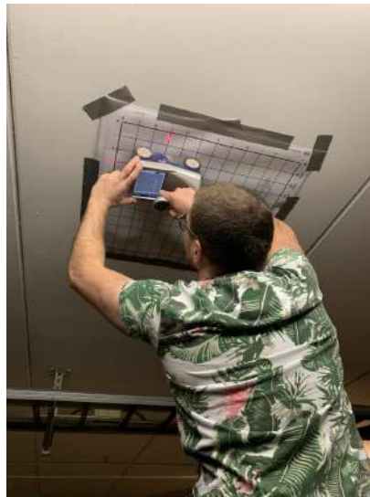
Figur 4-2 Mätning med Georadar. Bild: Författarnas egna
