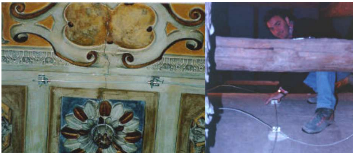
Figur 9-16 Montering av SOFO sensorer med L-järn
