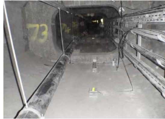
Figur 10-17 Sensor placering inne i lådan (Mistras Group, 2018)
