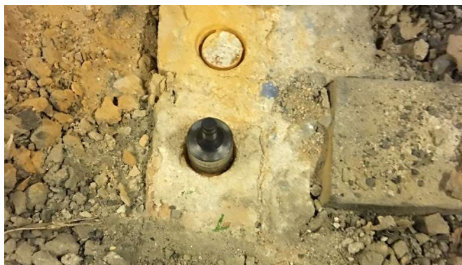
Figur 5.3. Test av vidhäftningsförmågan i murbruket på hjärtväggen av Pahl 7. Till nedre cylindern har stålpucken limmats fast. Ursågad cylinder i ovankant av testades därefter.
