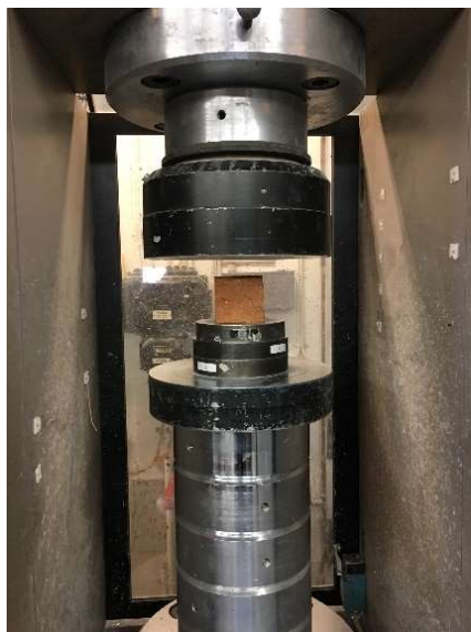
Figur 5.2: Trycktest av kubformad provkropp.
