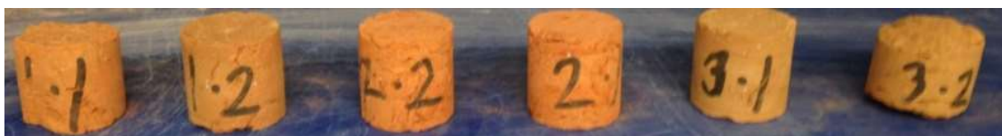
Figur 5.1: Provkroppar i form av cylindrar, från tryckhållfasthetstest (Foto: Alexander Eriksson-Brandels, 2018).
