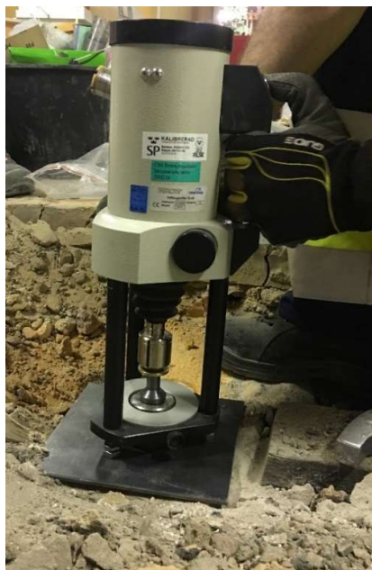
Figur 5.4 Förberedning av vidhäftningstest på hjärtväggen av Pahl 7.
