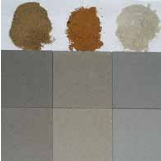
Verschiedene Sande und Zemente verleihen dem Betonstein verschiedene Farben: oben sind drei unterschiedliche Sande zu sehen, jede der beiden Plattenreihen wurde mit einem anderen Grauzement hergestellt.
