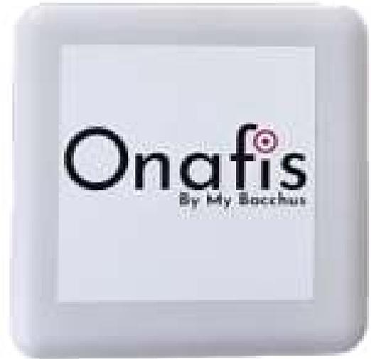
Los datos recopilados por los sensores se envían por Bluetooth al módulo Manager, que registra las medidas en la aplicación Onafis. De este modo, la transmisión de datos se realiza en tiempo real.
