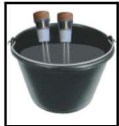
Nettoyage des bondes dans un seau d'eau sulfitée à 10%
