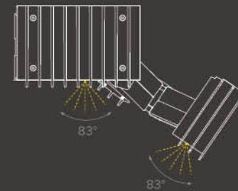
Ambient LED on the upper part of the arms to radiate the light on the fabric and thus generate a suggestive effect / LED Ambient en la parte superior de los brazos, para irradiar luz sobre la lona y de esta forma crear un efecto sugestivo.
