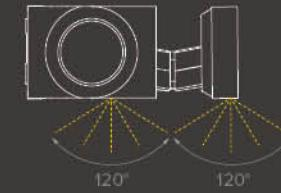
Ambient LED on the upper part of the arms to radiate the light on the fabric and thus generate a suggestive effect / LED Ambient en la parte superior de los brazos, para irradiar luz sobre la lona y de esta forma crear un efecto sugestivo.
