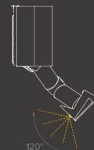
Ambient LED on the upper part of the arms to radiate the light on the fabric and thus generate a suggestive effect / LED Ambient en la parte superior de los brazos, para irradiar luz sobre la lona y de esta forma crear un efecto sugestivo.
