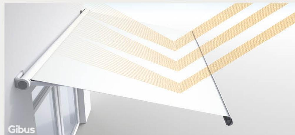
**ES** Los toldos de brazos son sistemas sombreantes ideados para proteger del sol la fachada y la superficie subyacente. La lona, integrada en el frontal, está tensada horizontalmente por brazos mecánicos dotados de resortes de acero que producen el empuje necesario para tensar la tela de manera uniforme.
