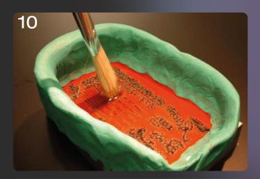
Mit Wattestäbchen oder einem Pinsel die Säure 10 Minuten lang in Bewegung bringen und betupfen, um einen Austausch der Säure an der Gravur zu gewährleisten und um eine Gravurtiefe von 0,1 -0,15 mm zu erreichen.
