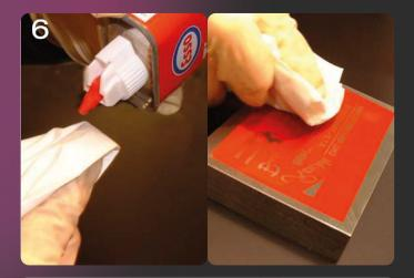
Um evtl. Kleberückstände zwischen den Buchstaben zu entfernen, muss nach dem Abziehen der Schutzfolie etwas Feuerzeugbenzin auf ein weiches (Papier-) tuch gegeben und vorsichtig über die Folie gestrichen werden. Dabei muss leicht gepustet werden, damit das Benzin sofort wieder verdampft.
