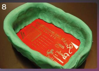
Mit Knetmasse muss um die zu ätzende Stelle ein außen gut abgedichteter Damm gebaut werden, damit beim Ätzvorgang die Säure nicht ausfließen kann.
