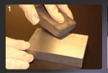
Die zu ätzende Stelle muss abolut fettfrei gemacht werden, z.B. mit Schmirgelpapier, Schleifgummi, Benzin oder Nitro Verdünnung. Die Oberfläche sollte eine Körnung von 220 - 320 Korn oder feiner haben.
