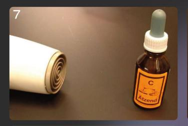
Bei einer kalten Form wird empfohlen, die Säure auf ca. 30-35°C (handwarm) zu erwärmen. Dadurch wird die Säure aggressiver.
