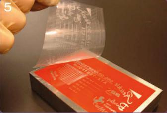
Bevor die Folie ganz abgezogen werden kann, muss an kleinen Buchstaben überprüft werden, ob noch rote Lackrückstände auf der Schutzfolie erkennbar sind. Wenn ja, muss die Folie wieder zurückgelegt und diese nochmals leicht aufgerieben werden.
