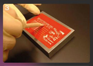
Die Ätzfolie an der gewünschten Stelle positionieren und mittels eines Schabers oder eines Aufreibeholzes aufreiben.
