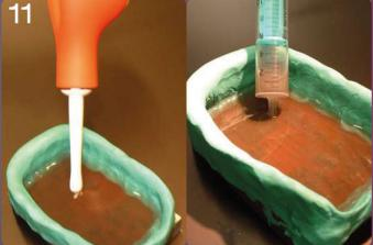
Die Säure mit einer Pipette oder Ähnlichem absaugen. Die Reststände der Säure mit saugfähigen Tüchern abtupfen und die Ätzstelle mit Öl besprühen, um den Säurevorgang zu beenden.
