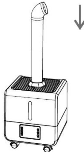
**Abb. 2** - Installieren Sie die Tankabdeckung und das Steigrohr mit Tülle. Netzkabel anschließen und betätigen Sie die Ein-/Aus-Taste
