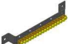
zbiralka za izenačevanje potencialov, 210 mm x 30 mm x 3 mm, (D x Š x V), za izenačevanje potenciala in povezavo na ozemljitev.
