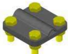
sponka, sestavljena iz 3 ploščic dimenzij 58 mm x 58 mm in 4 vijakov ter matic M8, namenjena izvedbi merilnih in ostalih spojev med okroglimi in ploščatimi vodniki do širine 30 mm v zemlji in nad njo.
