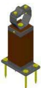
**zidni nosilec**, izdelan iz hrastovega lesa, primeren za lesene, vnetljive stene, vodnik se na nosilec pritrjuje z vijačenjem.
