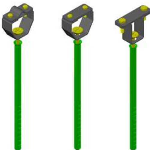
**zidni nosilec**, izdelan iz nerjaveče pločevine (Rf), primeren za votle stene z izolacijo do 140 mm, z vijakom 200 mm in PVC-vložkom Ø10 mm, vodnik se na nosilec pritrjuje **z vijačenjem**.
