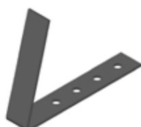
**pritrdilni komplet** za postavitev lovilne palice LOP01, na pločevinaste kritine. Lovilna palica se na pritrdilni element pritrdi s pomočjo ustrezne sponke KON02. Pritrdilna konstrukcija se na pritrdilni element pritruje s pomočjo ustreznega vijaka. Lovilne palice LOP02, LOP03, LOP04 je potrebno dodatno sidrati z "V" ali "I" distančnimi elementi.
