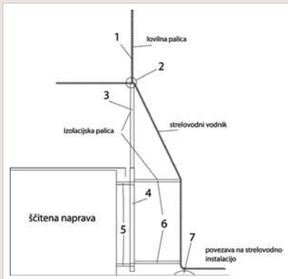
Izoliran nosilni element
