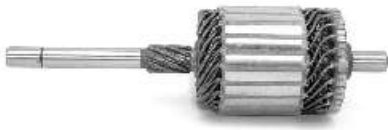
IM 246 12 V Replacing: 130949, 618687, NE296 Servicing: 534002A, 534003ABC, 534004AB, 534005ABC, 6246AC Slots: 23 O.D.60,5 L. 209,5
