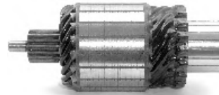
IM 3161 12 V 2.2 Kw Start&Stop Replacing: 594683 Servicing: D7G26, TS22E26 Slots: 19 Teeth: 16 O.D. 49,7 L. 118,7
