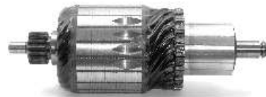
IM 3163 12 V 1.8 Kw Start&Stop Replacing: 235870 Servicing: 458414, ESW20ER121 Slots: 19 Teeth: 14 O.D. 49,7 L. 145,5
