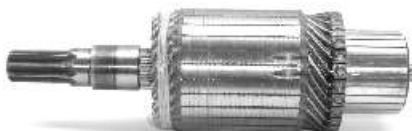
IM 3136 12 V 2.3Kw Servicing: 8973658240, S13-555, S13-555A Slots:27 Teeth:9 O.D.52,8 L. 173,0
