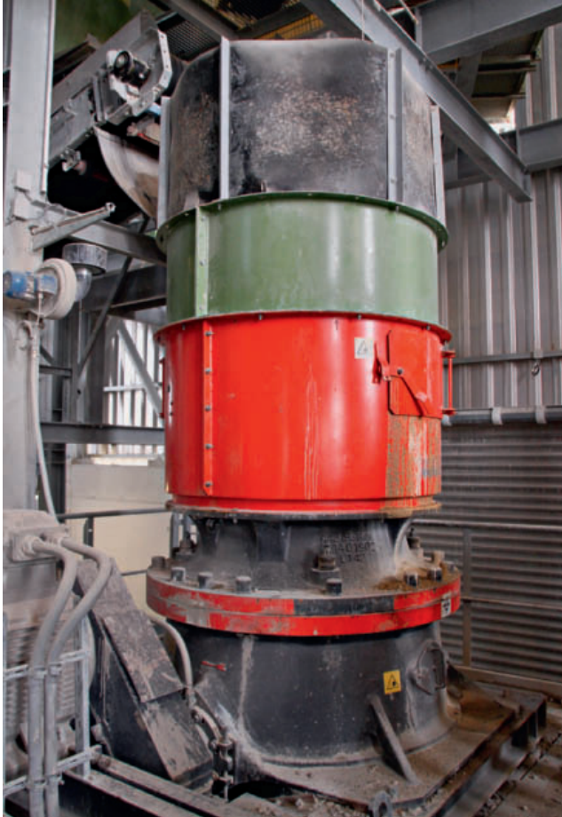
14 Kegelbrecher von Sandvik für die Splittproduktion Sandvik cone crusher for the production of chippings
