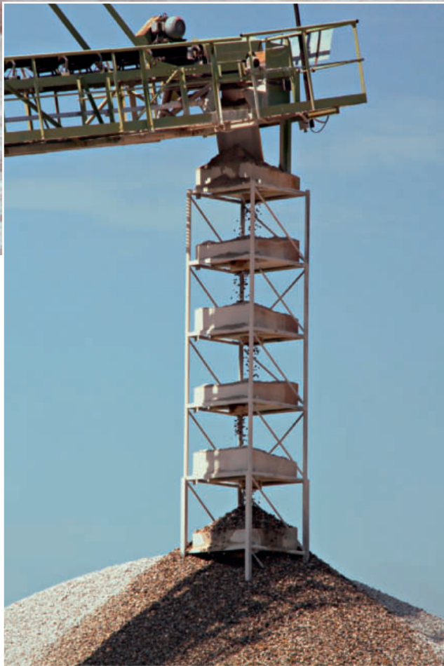
2 Die ASE Kiesleiter, um bei hoher Fallstrecke großer Körnungen Mehlkorn zu vermeiden • The ASE Gravel ladder to avoid powder grain when larger sizes fall large distances
