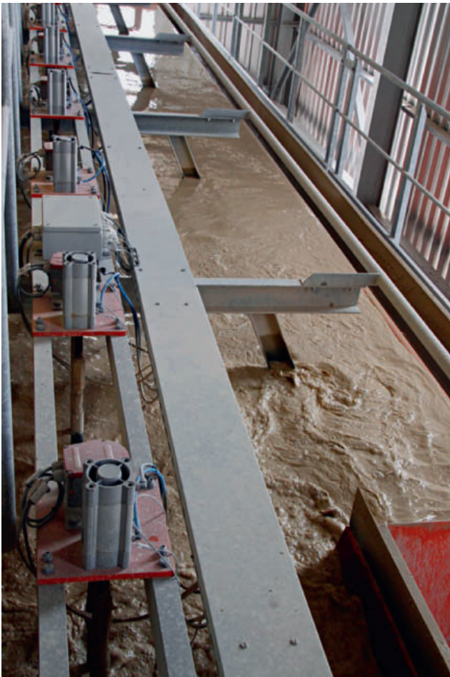
24 Im Freifallklassierer AKOREL wird Sand nach Rezept erzeugt In the AKOREL freefall classifier, the sand is produced according to recipe
