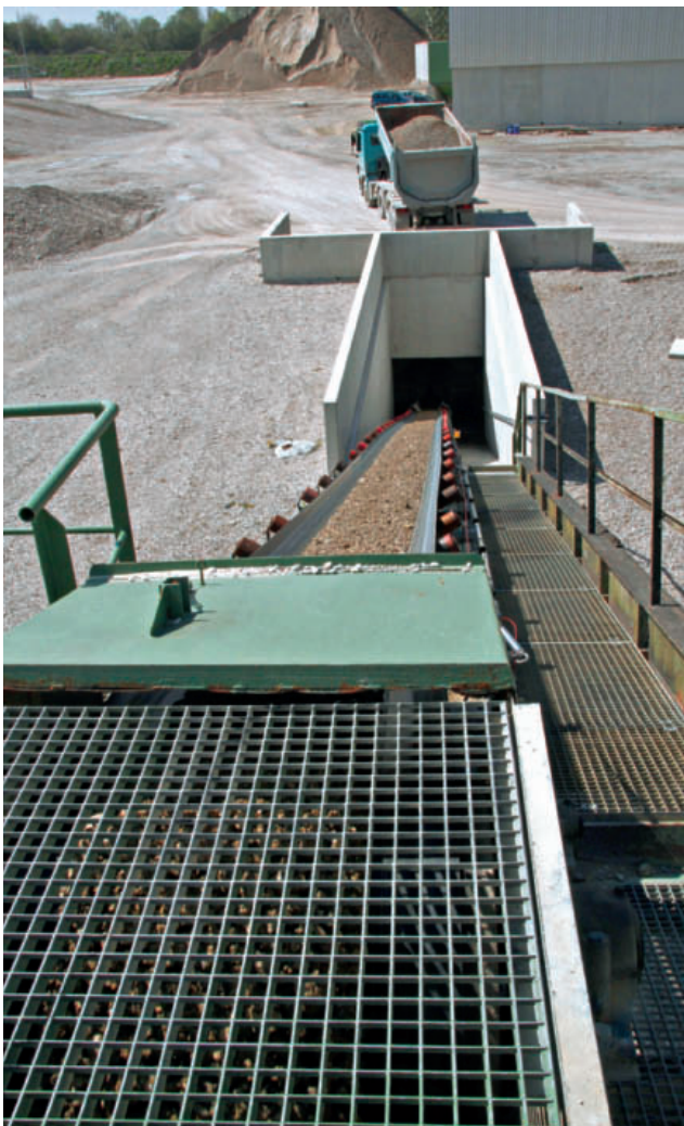
8 Über Band gelangt das Rohmaterial aus dem Bunker auf eine große Vorratshalde • The raw material is sent on a belt from the bin to a large stockpile
