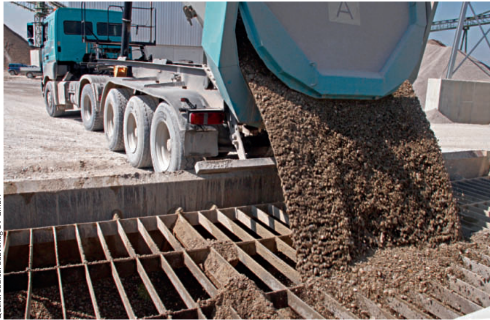
7 Das Rohmaterial wird zunächst in einen zentralen Bodentrichter gekippt The raw material is first tipped in a central bottom hopper
