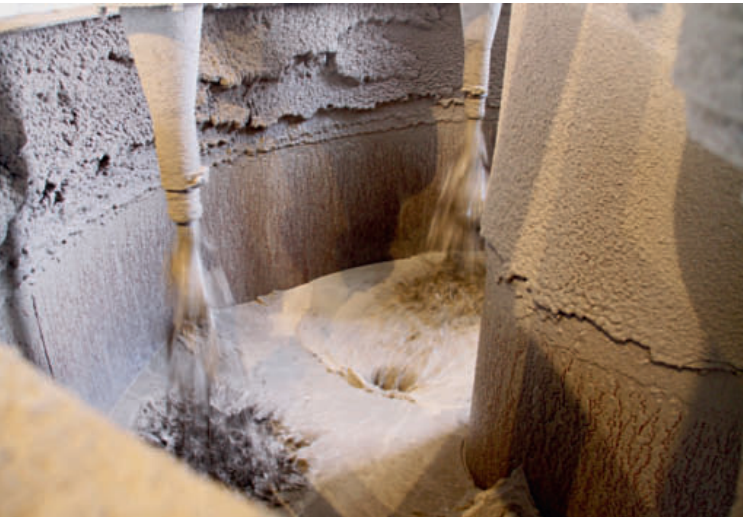
20 Feinstpartikel werden für die weitere Verarbeitung im Freifallklassierer abgezogen • The very fine particles are removed for further processing in the freefall classifier
