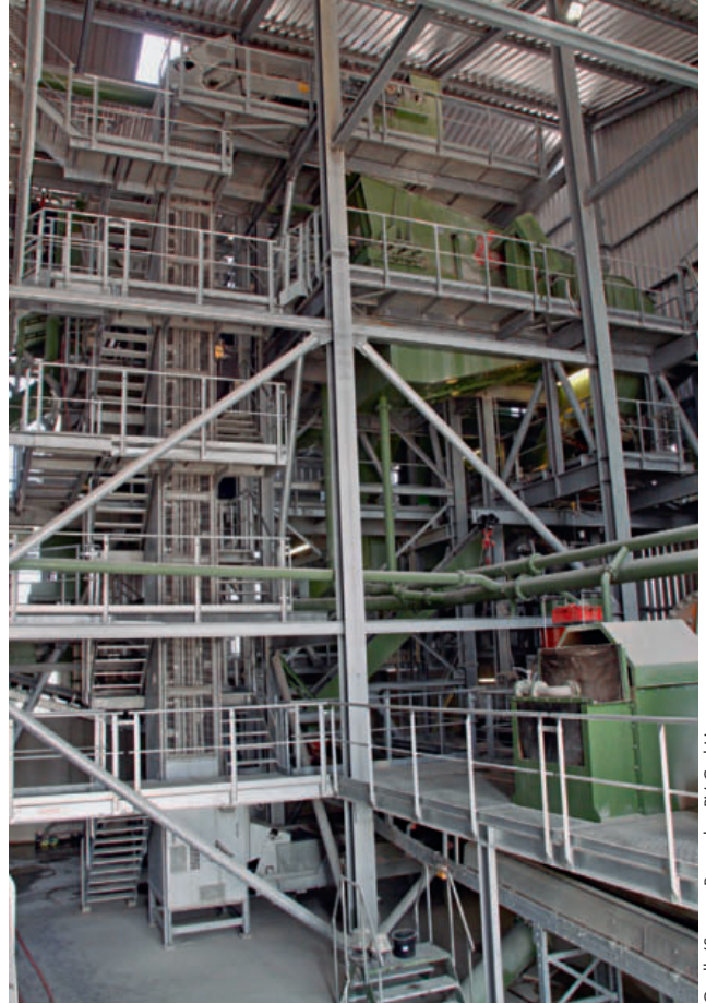
15 Über den VHV Doppelgurtförderer (C-förmig) in der linken Bildhälfte gelangt das Überkorn zurück in den Brechkreislauf On the VHV double-belt conveyor (C-form) in the left half of the photo the oversize is returned to the crushing circuit
