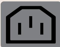
In diese EINGANGSBUCHSE wird der STECKER des Netzkabels der Rückwand gesteckt. Achten Sie darauf, dass dieses Kabel immer fest eingesteckt ist.
