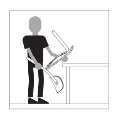
INSTALL THE FRONT LEGS / DO NOT TIGHTEN THE REAR LEGS SCREWS FIRMLY YET
