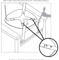
INSTALL THE BACKREST BEFORE TIGHTENING THE REAR LEGS
