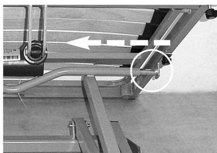
☞ Nehmen Sie den kopfseitigen halben Liegeflächenrahmen [1] und schieben den Rohrstutzen des Haltebocks [9] in das andere offene Ende des V-Rohres.
