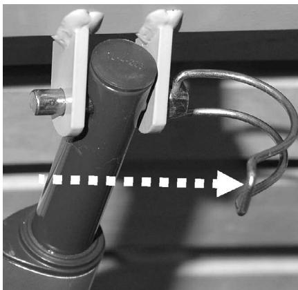
☞ Der zweite Anwender entfernt nun den Sicherungssplint am Hubrohr des Rückenlehnenmotors. Schwenken Sie dafür den gebogenen Bügel weg und ziehen den Sicherungssplint mitsamt dem Bügel aus der Hubstange des Rückenlehnenmotors heraus.
