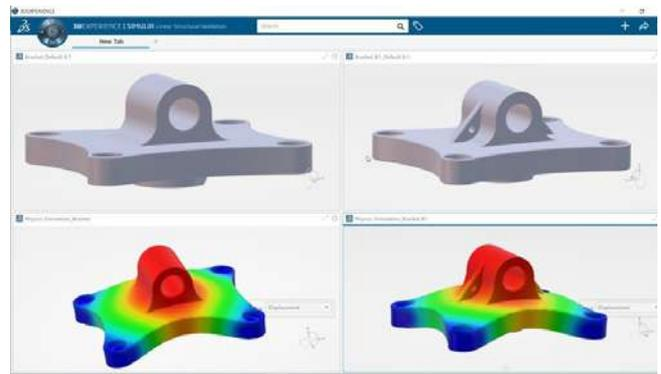
Compare con facilidad los resultados de la simulación estructural lineal durante el proceso de diseño.
