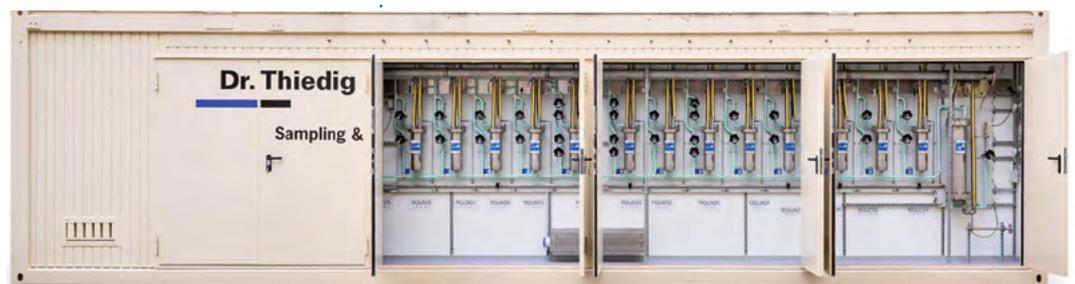
Probenahmecontainer mit separat angeordneten Hochdruck-Komponenten (Conditioning Part)
