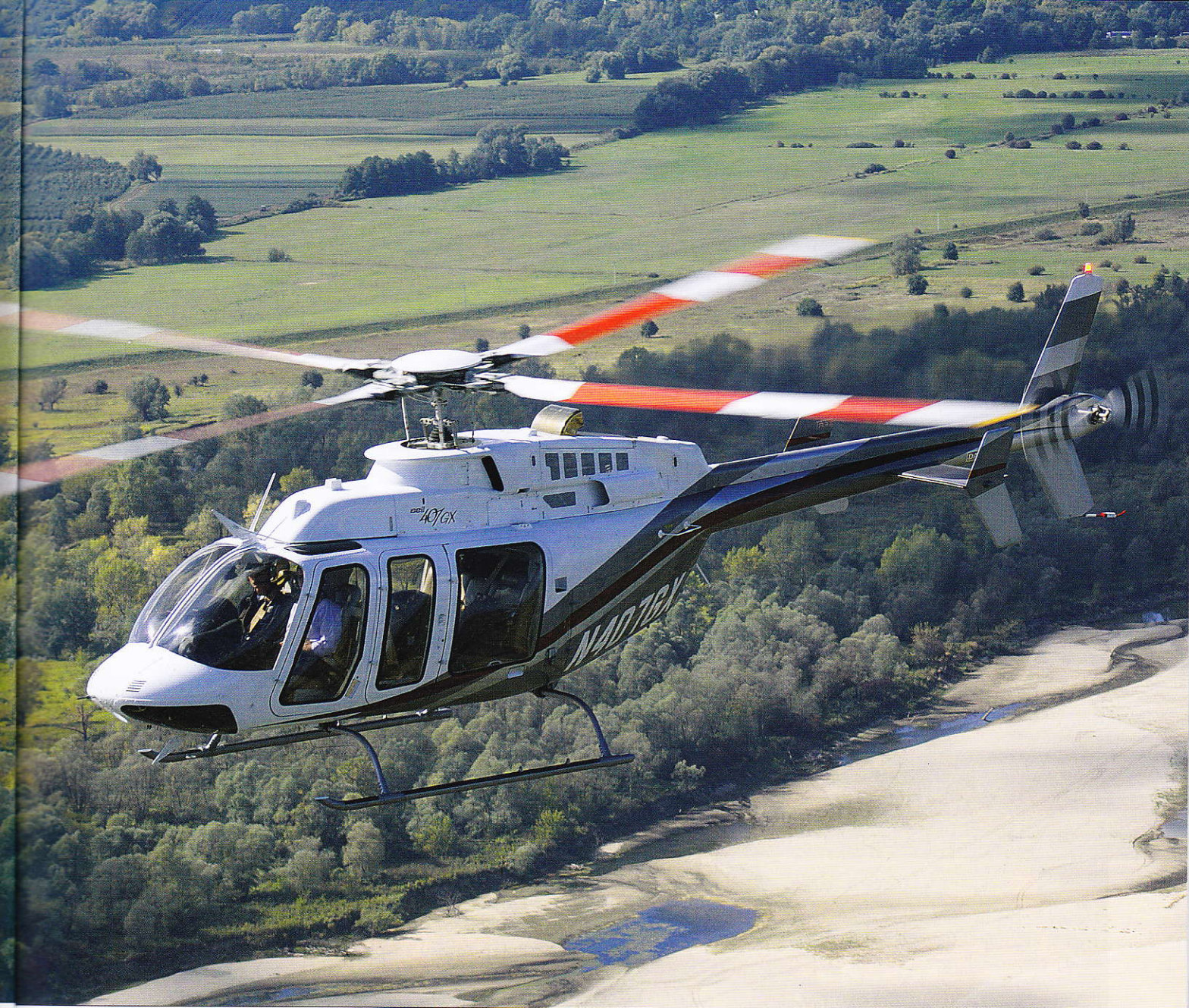
Specjalny tryb Quiet Cruise pozwala obniżyć hałas na przelocie przez zmniejszenie obrotów wirnika
