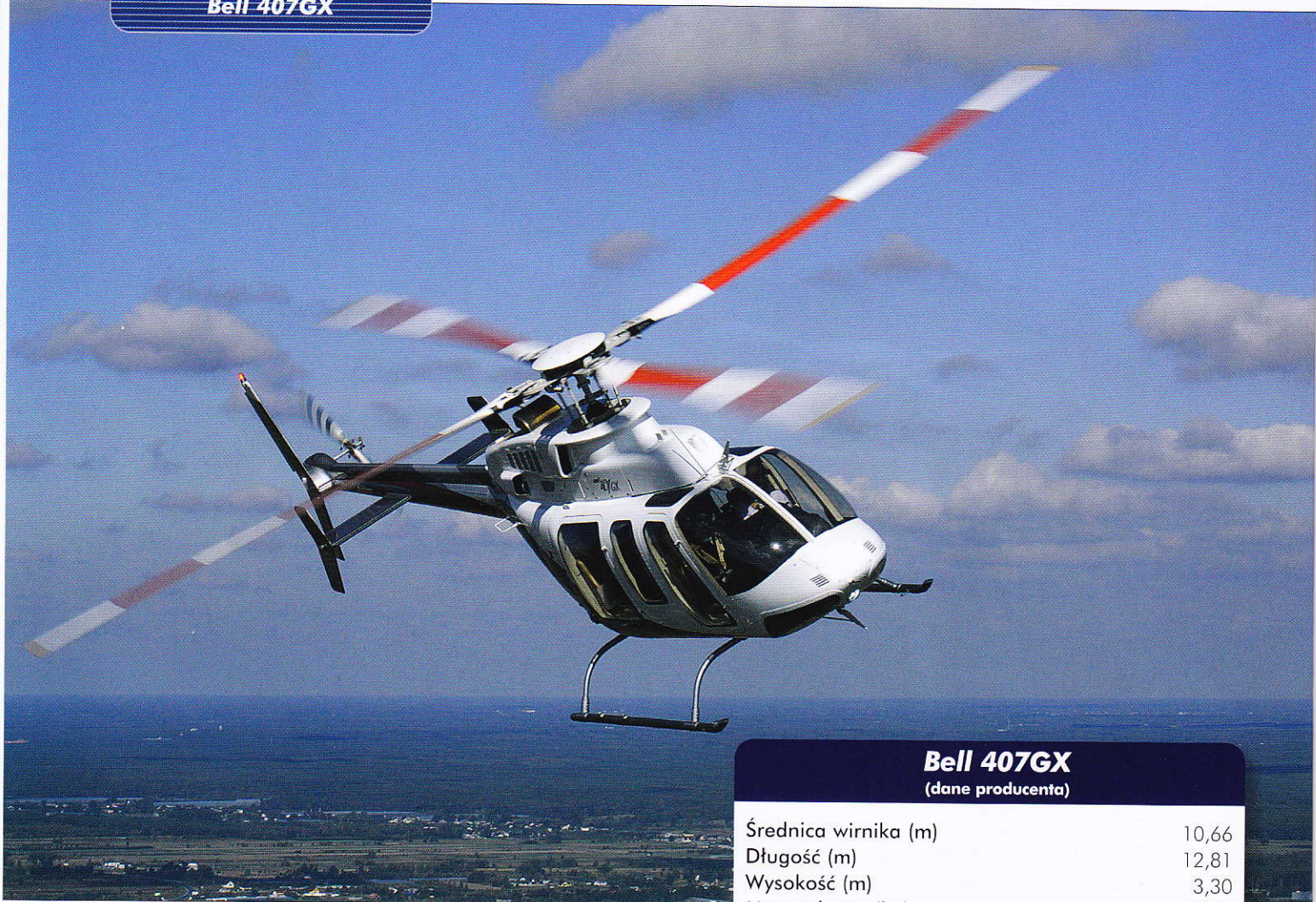
Czteropłatowy wirnik główny zapożyczono z wojskowego OH-58 Kiowa (Bell 406)
