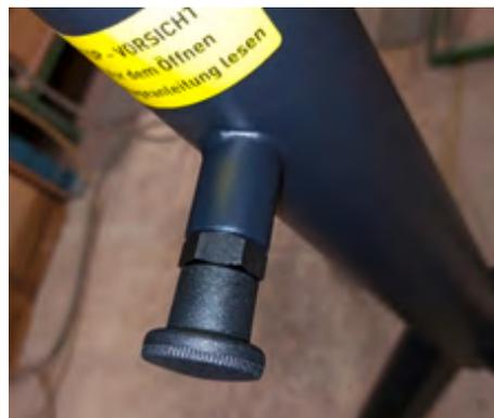
Bei zunehmender Beladung verringert die Unterstützung durch die Gasdruckfeder! Das Oberteil darf nicht bei geöffnetem Sperrstift gegen das Unterteil verdreht werden! **Beschädigungs- und Kippgefahr!**
