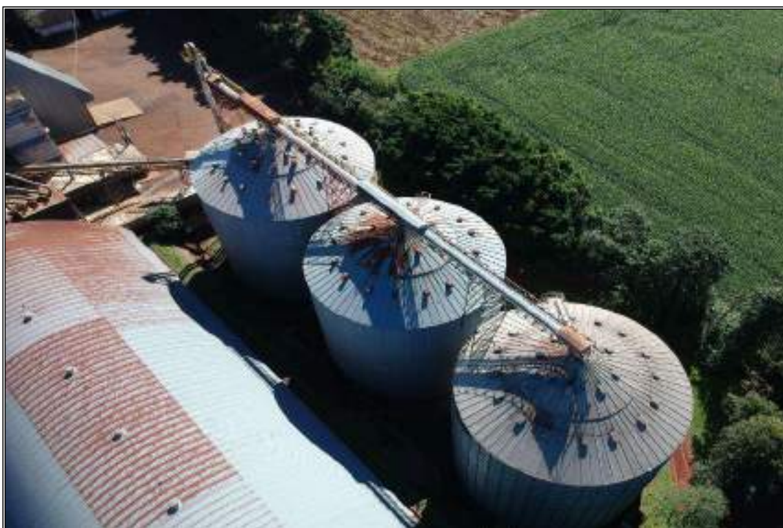
ITEM 1,032 - VISTA DA CORREIA TRANSPORTADORA SUPERIOR PARA CAPTAÇÃO DE GRÃOS DO ELEVADOR DE CANECAS PARA OS SILOS 1, 2 E 3
