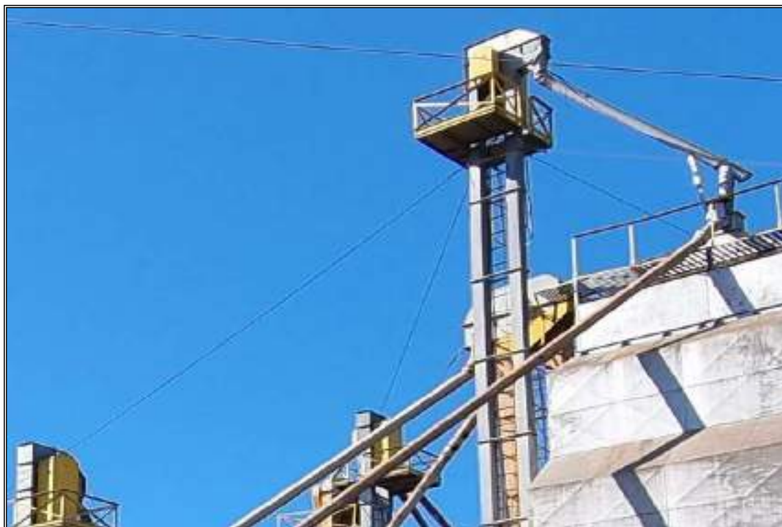
ITEM 1,027 - VISTA DO ELEVADOR DE CANECAS PLÁSTICA PARA CAPTAÇÃO DE GRÃOS DO SECADOR PARA DESCARREGAMENTO
