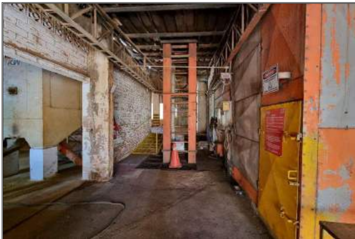
ITEM 1,017 - VISTA DO SECADOR DE COLUNA PARA GRÃOS CAP: 60 TON
