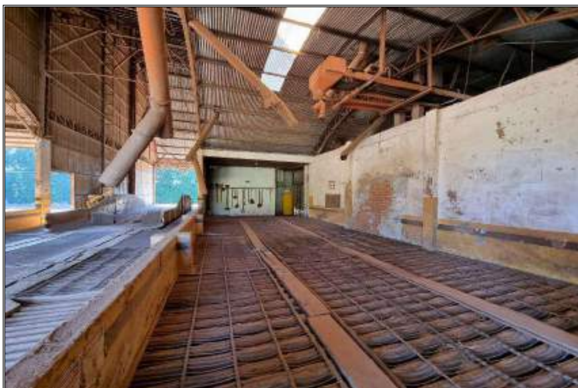
ITEM 1,005 - VISTA DA MOEGA DE DESCARGA DE GRÃOS COM ESTRUTURA EM CONCRETO CAP: 600 TON
