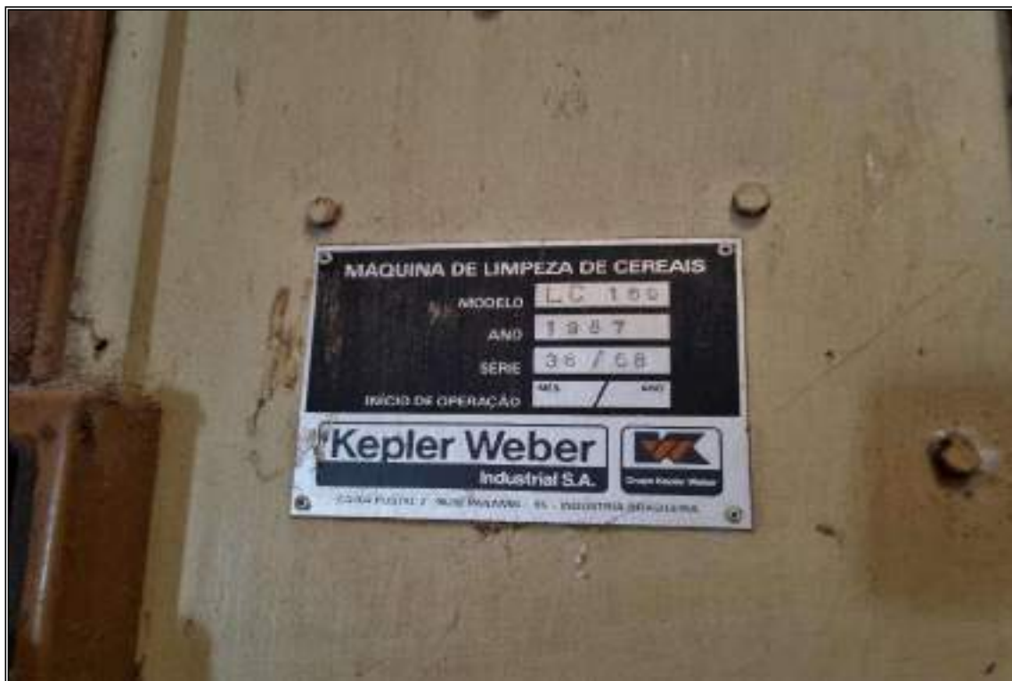
ITEM 2,005 - VISTA DA PLACA DE IDENTIFICAÇÃO DA MÁQUINA DE LIMPEZA MARCA: KEPLER WEBER MODELO: LC 160 SÉRIE: 36/08
