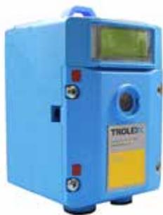
Supervisión de entornos de minas en la totalidad de la mina mediante el sensor de supervisión atmosférica (AMS) inalámbrica Strata/Troxel alimentado por pilas, el cual ha sido aprobado como intrínsecamente seguro. Es compatible con la calibración subterránea y de superficie. Entre los gases se incluyen el CO, el CH<sub>4</sub>, el H<sub>2</sub>S y otros
