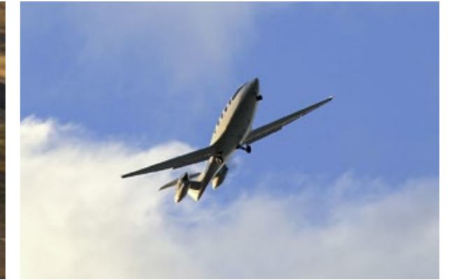
Die GFK-Bauweise und der Elektroantrieb gestatten eine Anordnung der leichten Motoren im Heck des E-Flugzeugs
