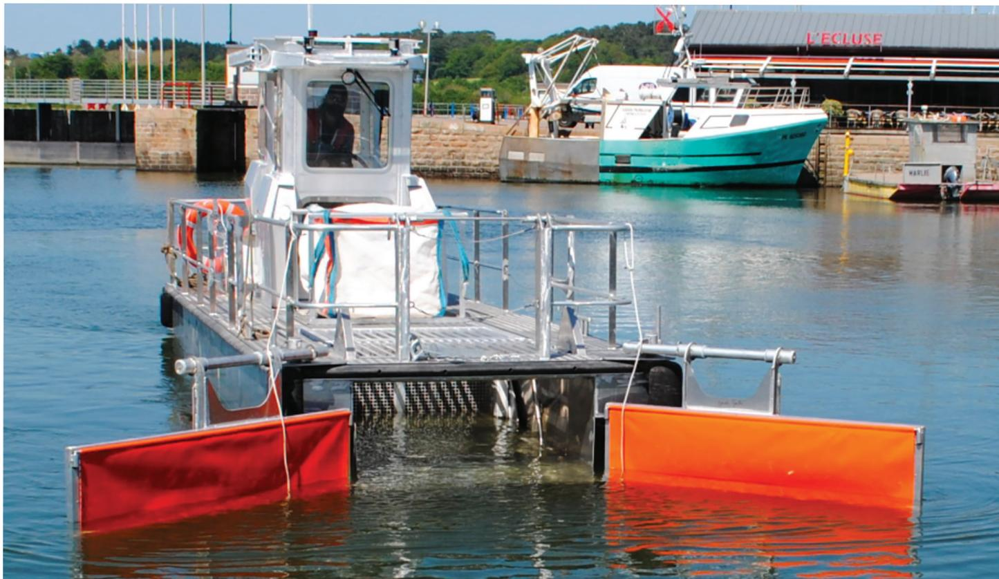
Le Waste Cleaner 92 est un navire de dépollution doté d'une **technologie unique et innovante** pour la collecte des déchets flottants solides et liquides incluant les hydrocarbures.
