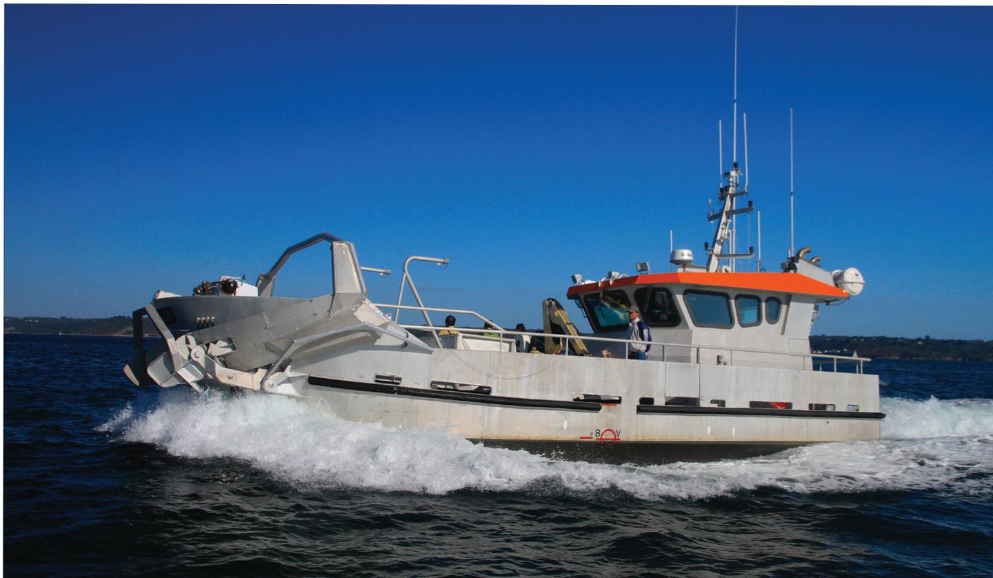
Le MultiCleaner 128 est un navire multifonctions doté d'une **technologie de dépollution unique et innovante** pour la collecte des déchets flottants solides et liquides incluant les hydrocarbures.
