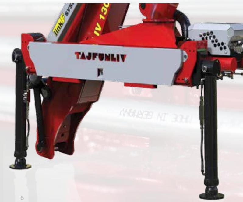
In den Hub- und Schwenkarm sind Hydraulikschläuche integriert. Die abnehmbare Abdeckung am Schwenkarm ermöglicht einen einfachen Zugang zu den Schläuchen und deren schnellen und einfachen Austausch.
