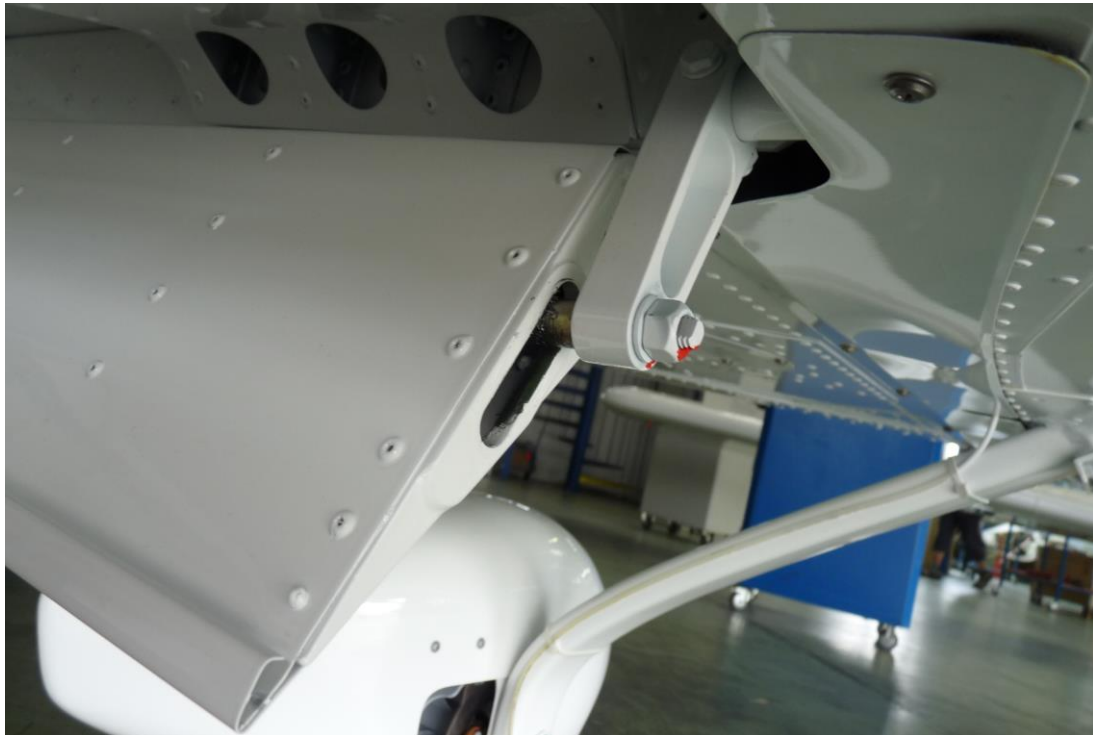
Obr. 8 – Celkový pohled na ovládání levé klapky
