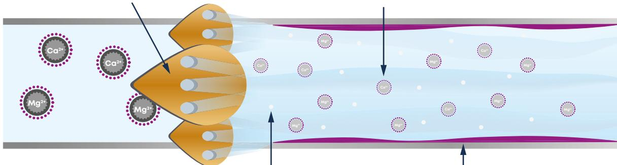
Durch die Entgasung und Freisetzung von leichter Kohlensäure können sich bestehende Kalkablagerungen lösen und werden somit abgebaut und ausgeschwemmt.
