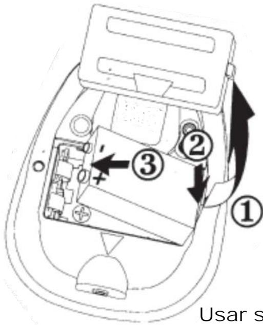
2. Coloque el programador boca abajo y presione con firmeza para levantar la tapa del compartimiento de la batería.
