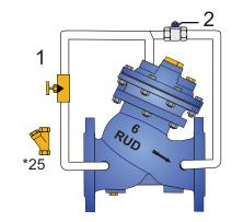
Esta Válvula, lleva montada, exteriormente, Una válvula de esfera (2) y una válvula de aguja (1) que facilita su operación y mantenimiento. Opcionalmente se puede instalar filtro "Y" (25) a solicitud.
