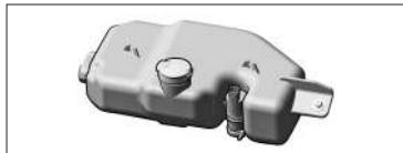
Рис. 7. Бачок стеклоомывателя
