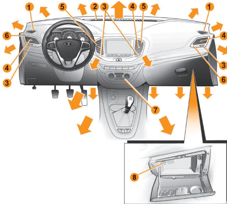
Рис. 3. Органы управления системой вентиляции и отопления салона (*в вариантом исполнении*)
