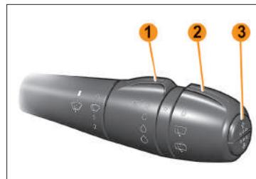
Рис. 18. Рычаг правого подрулевого переключателя
