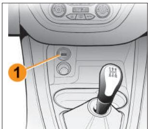
Рис. 8г. USB-разъем для подключения USB-накопителя
