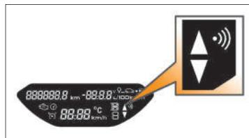
**В вариантом исполнении** на автомобиле активирована функция подсказчика переключения передач.
