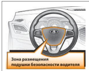
Рис. 4. Место установки фронтальной подушки безопасности водителя
