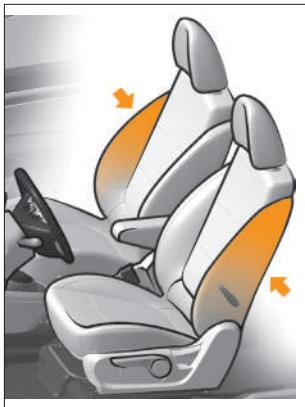
Рис. 6. Места установки боковых подушек безопасности для водителя и переднего пассажира (в вариантом исполнении)
