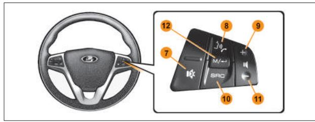
Рис. 2б. Блок управления мультимедийной системой
