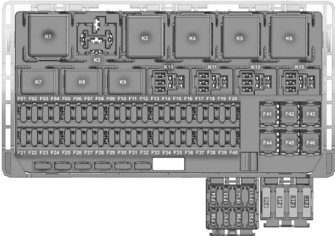
Рис. 3а. Расположение предохранителей и реле в монтажном блоке салона (в вариантом исполнении)
