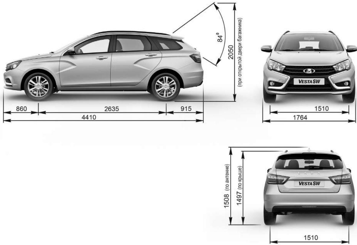
Рис. 4. Габаритные (справочные) размеры автомобиля Vesta SW (в вариантом исполнении)
