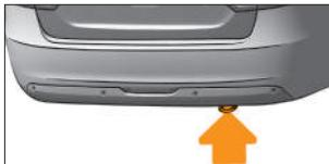
Рис. 10. Расположение задней буксирной проушины
