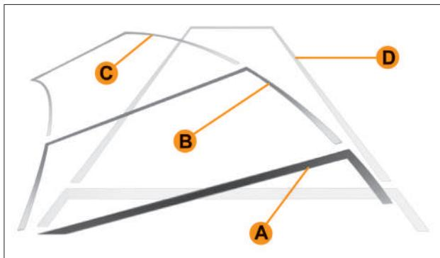
Рис. 2.4. Парковочные линии при вращении рулевого колеса влево до упора (в вариантом исполнении)
