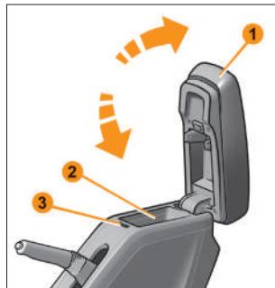
**⚠** Подъём подлокотника производить за переднюю часть без резкого отбрасывания назад.
