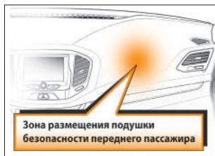
Рис. 5. Место установки фронтальной подушки безопасности переднего пассажира (в вариантом исполнении)
