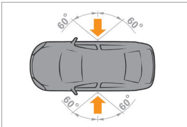
**Рис. 9. Зоны действия и срабатывания боковых подушек безопасности**
