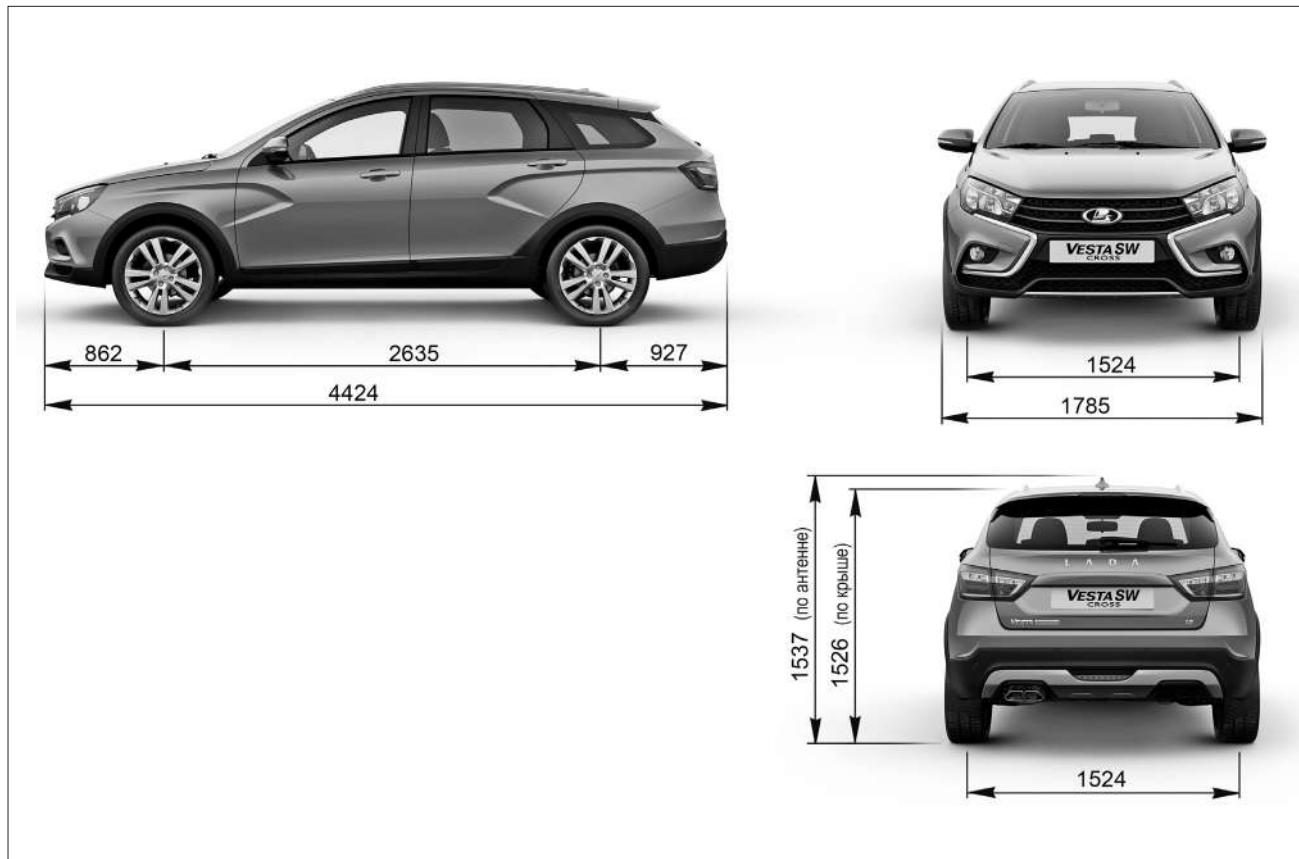
Рис. 5. Габаритные (справочные) размеры автомобиля Vesta SW Cross (в вариантом исполнении)
