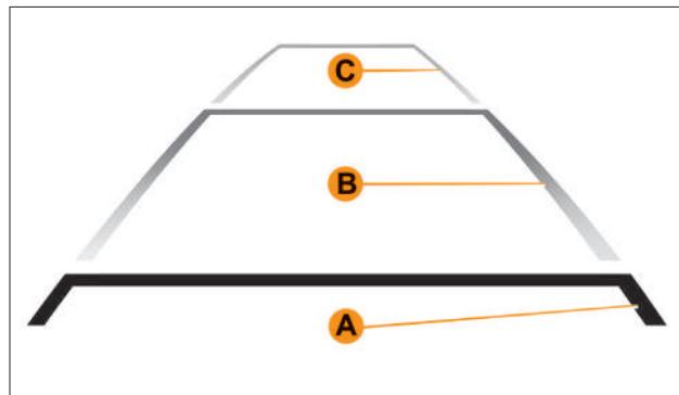
Рис. 2.2. Парковочные линии в нулевом положении рулевого колеса (в вариантом исполнении)
