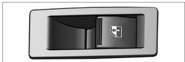
Рис. 12. Переключатель стеклоподъемника пассажирский
