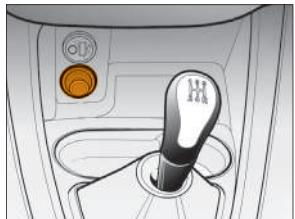
Рис. 2. Розетка для подключения дополнительного электрооборудования
