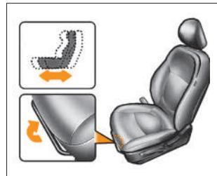
1. Немного наклонитесь вперед и поднимите рычаг регулировки угла наклона спинки сиденья.
