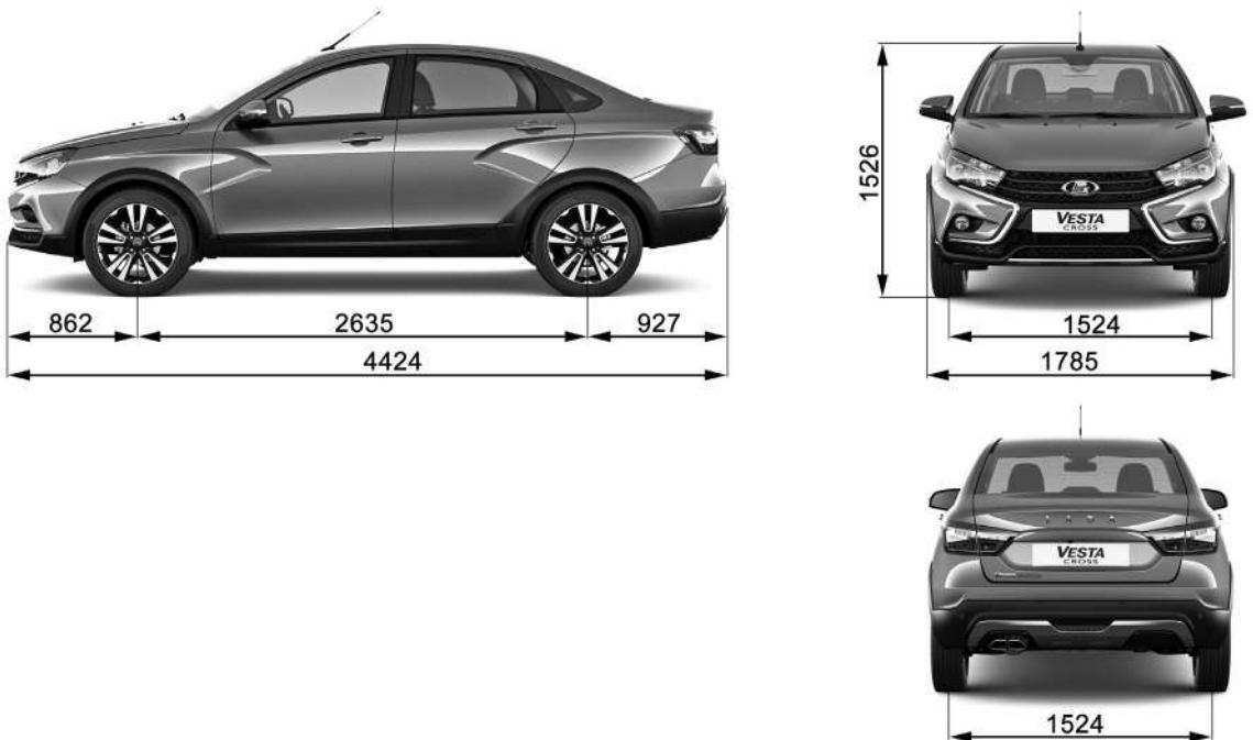
Рис. 3. Габаритные (справочные) размеры автомобиля Vesta Cross (в вариантом исполнении)
