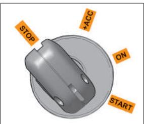
Рис. 2. Выключатель зажигания
