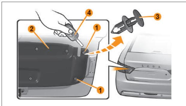
**Рис. 14. Замена ламп света заднего хода и габаритного огня
