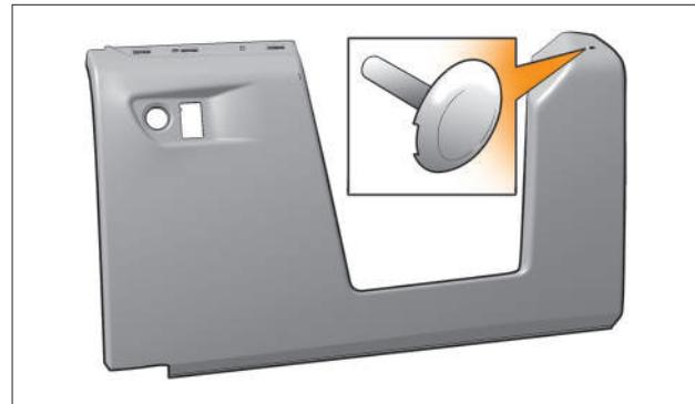
**Рис. 2. Крышка блока предохранителей**
