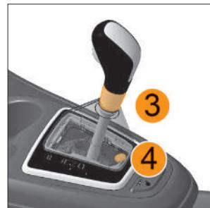
Рис. 21. Снятие блокировки рычага переключения передач
