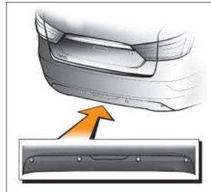
передачи. При этом раздается короткий звуковой сигнал низкого тона.
