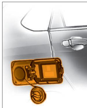
Рис. 5. Крышка люка и пробка наливной горловины топливного бака
