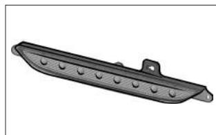
В качестве источников света в заднем противотуманном фонаре применены светоизлучающие диоды. Конструкция фонаря неразборная. В случае выхода из строя 2-х или более источников света задний противотуманный фонарь заменяется полностью на специализированной станции технического обслуживания.
