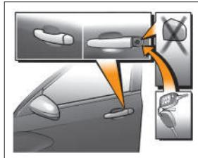
Рис. 4. Запирание и отпирание дверей вручную
