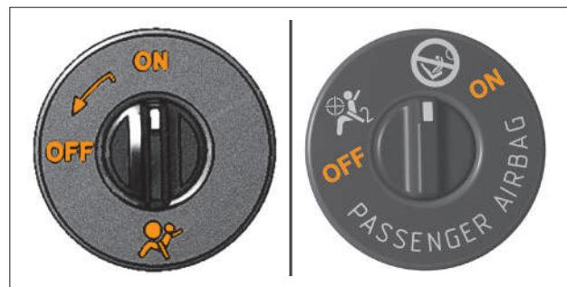
Рис. 13. Выключатель фронтальной подушки безопасности пассажира (в вариантом исполнении)
