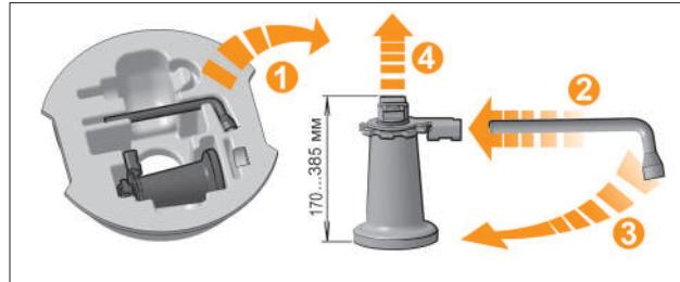
Рис. 8. Положение инструмента в органайзере (вариантное исполнение) и последовательность работы с домкратом
