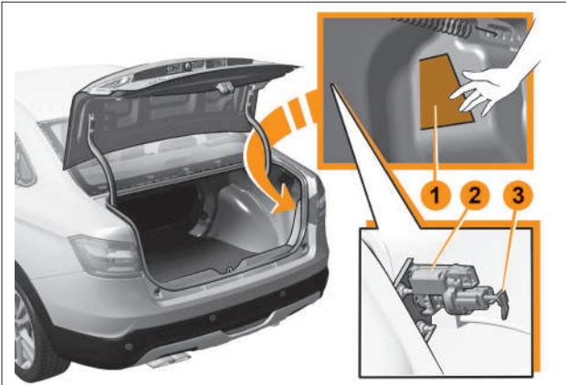
Рис. 7. Доступ к электроприводу (кузов «SE»)
