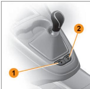
**В вариантом исполнении** автомобиля LADA Vesta передние сиденья также оборудованы электрическими подогревателями **1** и **2**, с возможностью ступенчатого изменения уровня нагрева, которые включаются при работающем двигателе выключателями, расположенными в блоке управления обогревом сидений. Для включения сиденья водителя необходимо нажать на выключатель **1** (см. рис.), для включения обогрева сиденья пассажира – на выключатель **2**.
