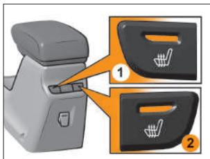
**В вариантом исполнении** автомобиля LADA Vesta задние сиденья оборудованы электрическими подогревателями, которые включаются при работающем двигателе выключателями (см. рис.), расположенными на задней стенке центрального подло-
