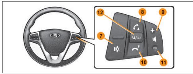
Рис. 2а. Блок управления радиоприемником
