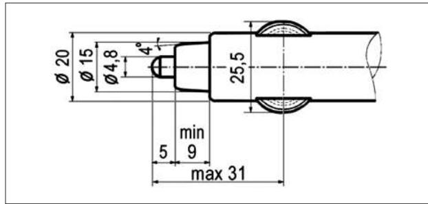
Рис. 3. Вилка электрического прибора для подключения дополнительного электрооборудования
