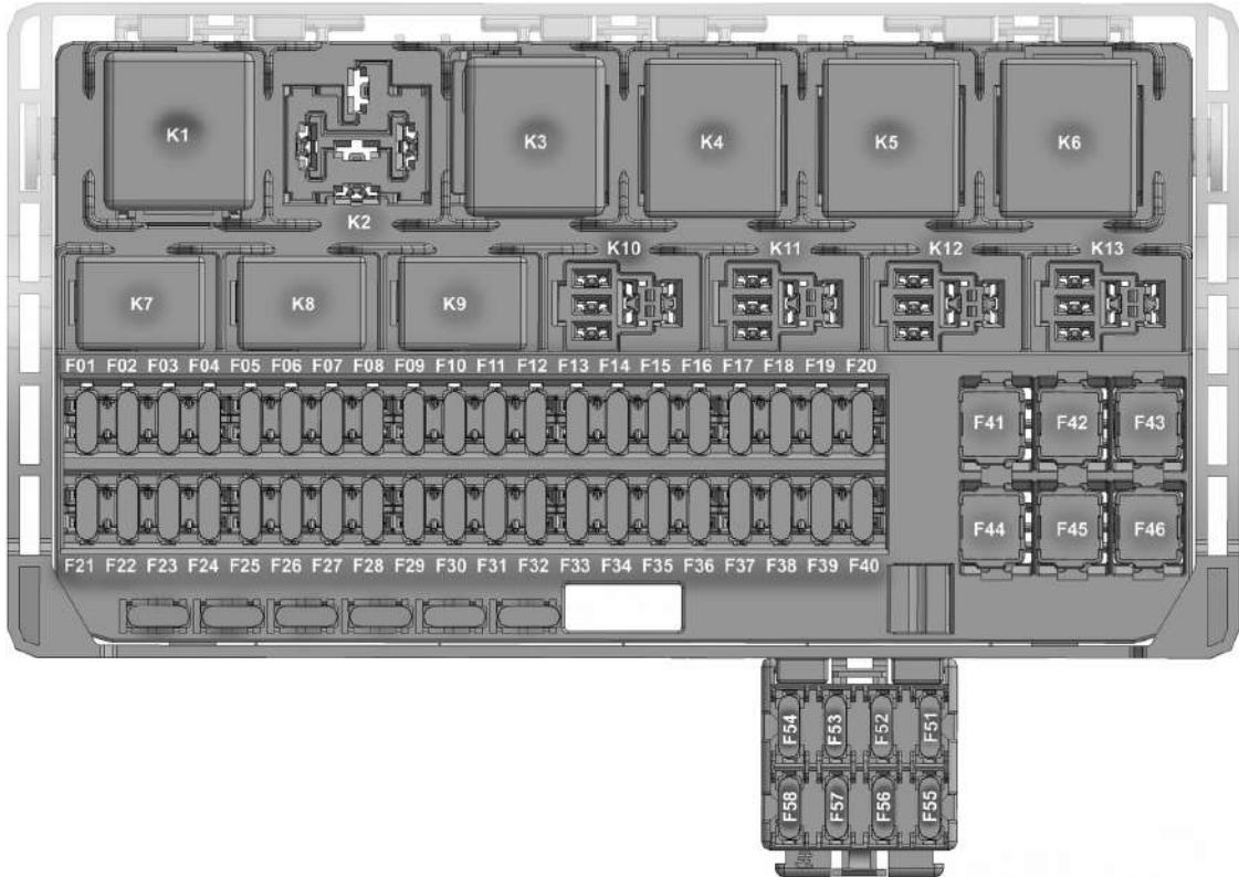
Рис. 36. Расположение предохранителей и реле в монтажном блоке салона (в вариантом исполнении)
