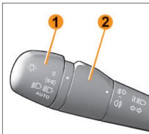
Рис. 16. Кольца управления на рычаге переключателя
