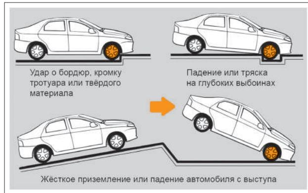
**Рис. 10. Примеры ситуаций с возможным срабатыванием подушек безопасности**
