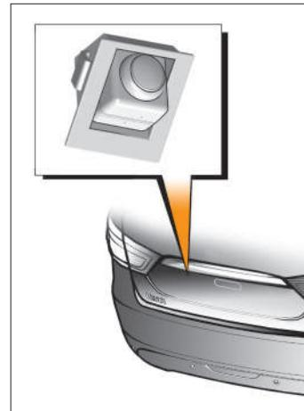
Рис. 1. Камера заднего вида
