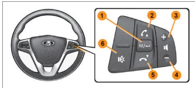
Рис. 6б. Блок управления радиоприемником
