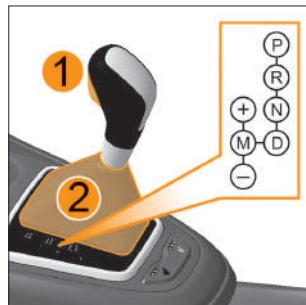
**Рис. 20. Рычаг переключения передач автоматической коробки передач**
