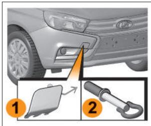
Рис. 9. Расположение передней буксирной проушины
