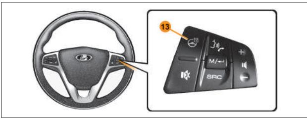
Рис. 2в. Кнопка включения подогрева рулевого колеса
