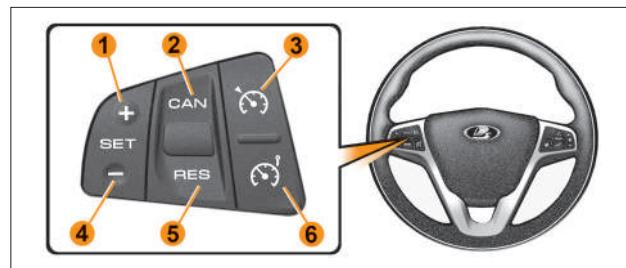
Рис. 1. Блок управления системами «Круиз-контроль» и «Ограничитель скорости» (в вариантом исполнении)
