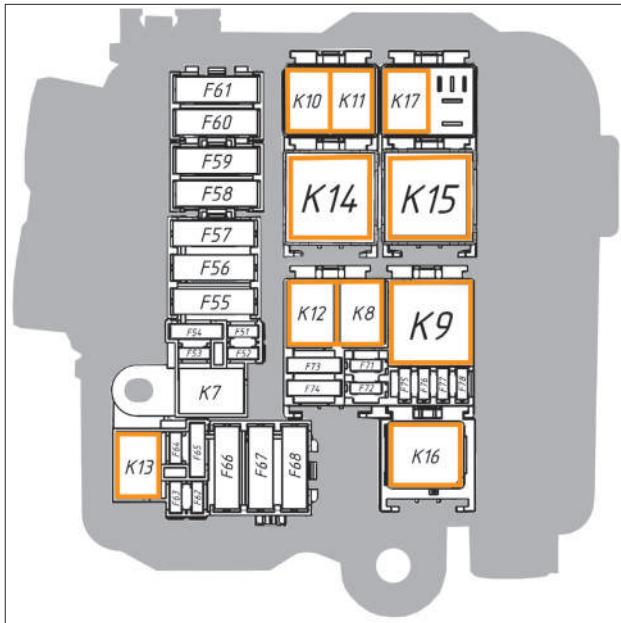
Рис. 8.4.2. Схема расположения предохранителей
