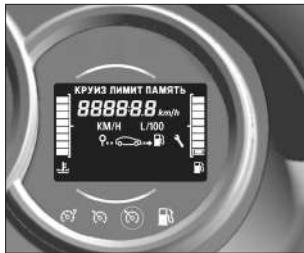
Рис. 3.3.1. Информационный дисплей комбинации приборов
