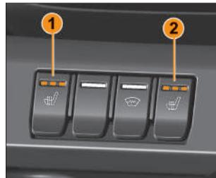
Рис. 2.1.6. Клавиши управления подогревом передних сидений (в вариантом исполнении)
