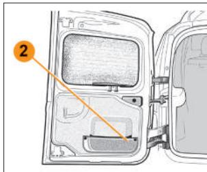
Рис. 4.5.8. Дополнительный карман в задней двери
