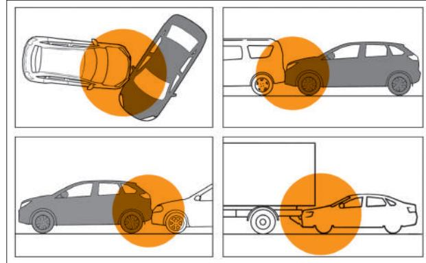
**Рис. 2.6.9. Примеры ситуаций с возможным несрабатыванием подушек безопасности водителя и переднего пассажира**
