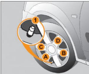
Рис. 6.9.2. Снятие и установка декоративного колпака (в вариантом исполнении)
