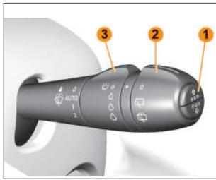
Рис. 3.9.8. Кольца и кнопки управления на правом рычаге подрулевого переключателя (в вариантом исполнении)
