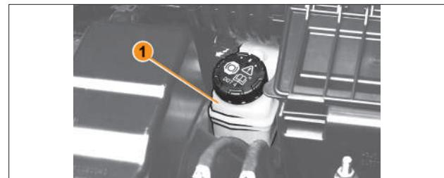
Рис. 6.6.1. Бачок тормозной системы
