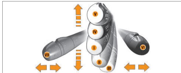
**Рис. 3.9.4. Положения левого рычага подрулевого переключателя (в вариантом исполнении)**
