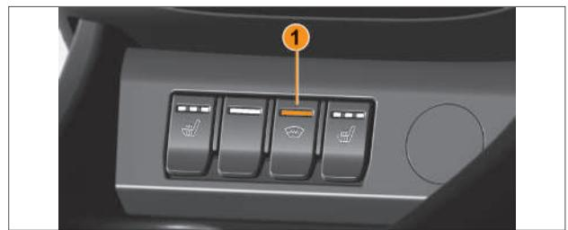
Рис. 3.12.4. Выключатель обогрева ветрового стекла
