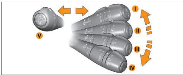
**Рис. 3.9.9. Положения правого рычага подрулевого переключателя (в вариантом исполнении)**
