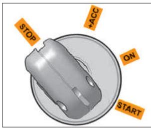
Рис. 3.5.1. Выключатель зажигания
