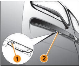
Рис. 6.13.8. Фонарь освещения номерного знака
