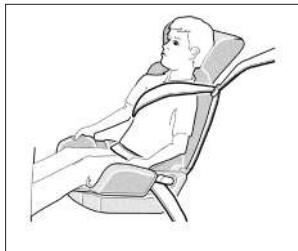
Рис. 2.8.1. Пример специальной подушки-бустера
