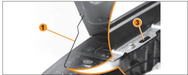
Рис. 6.2.4. Установка упора капота
