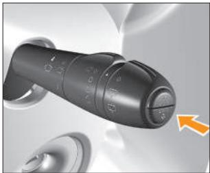
Рис. 3.3.2. Кнопки управления бортовым компьютером
