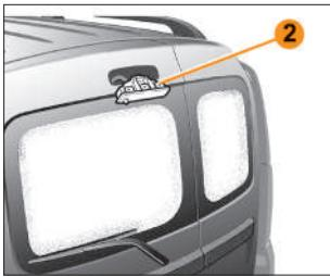
Рис. 6.13.7. Фонарь дополнительного сигнала торможения
