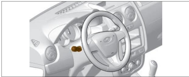
Рис. 3.9.1. Левый рычаг подрулевого переключателя
