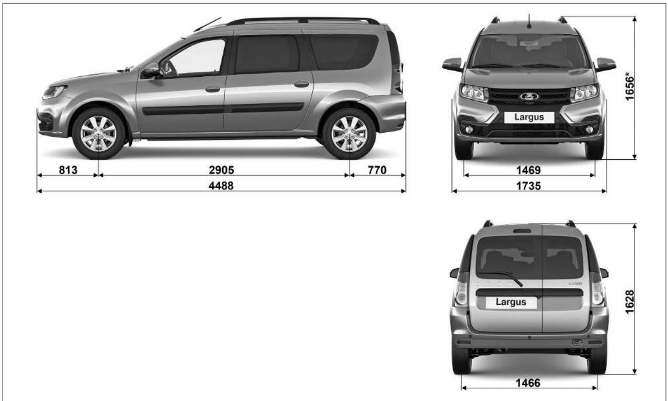
Рис. 7.2.1. Габаритные (справочные) размеры автомобиля Largus «универсал»
