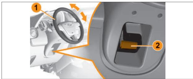
Рис. 3.4.1. Регулировка положения рулевого колеса
