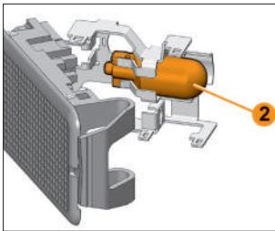
Рис. 6.13.12. Лампа освещения вещевого ящика (в вариантом исполнении)
