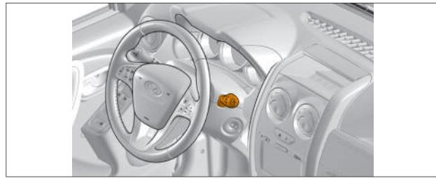
Рис. 3.9.6. Правый рычаг подрулевого переключателя
