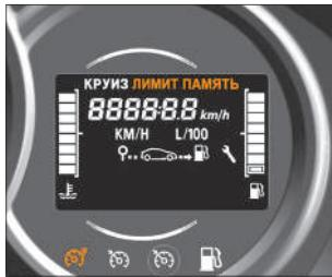
Рис. 5.11.2. Индикация системы «Ограничитель скорости» (в вариантом исполнении)
