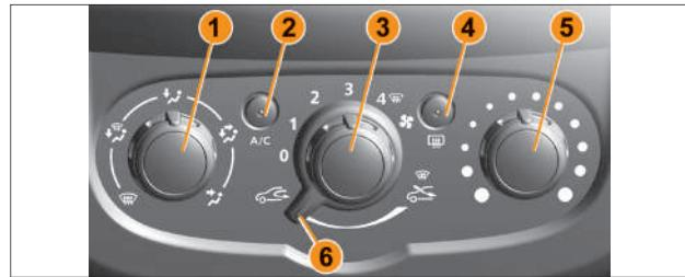
**Рис. 3.12.3. Блок управления климатической системой (в вариантом исполнении)**
