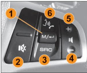
Рис. 4.6.4. Дополнительный блок управления мультимедийной системой (в варианте исполнении)
