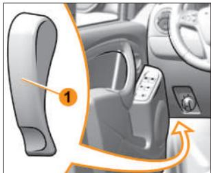
Рис. 6.2.1. Рукоятка разблокировки замка капота
