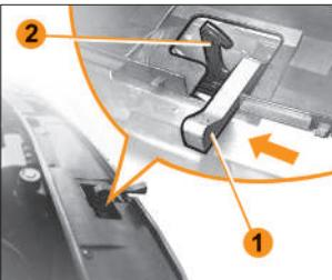
Рис. 6.2.2. Предохранительный крюк замка капота
