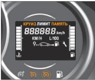
Рис. 5.11.3. Индикация системы «Круиз-контроль» (в вариантом исполнении)
