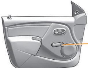
Рис. 4.1.1. Рукойтка привода стеклоподъемника
