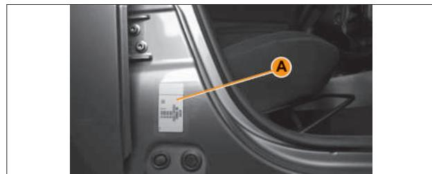
Рис. 7.1.1. Место размещения таблички изготовителя
