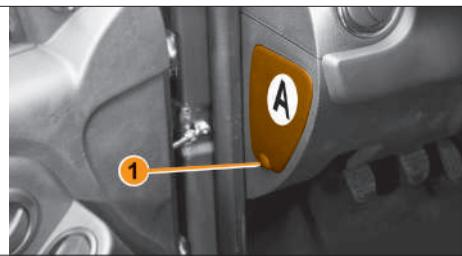
Рис. 6.12.1. Крышка монтажного блока салона
