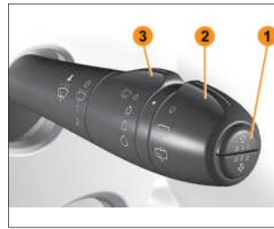
Рис. 3.9.7. Кольца и кнопки управления на правом рычаге подрулевого переключателя (в вариантом исполнении)
