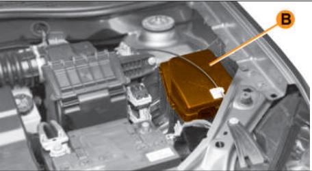
Рис. 6.12.2. Крышка монтажного блока
