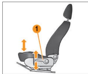
Рис. 2.1.3. Регулировка сиденья водителя по высоте
