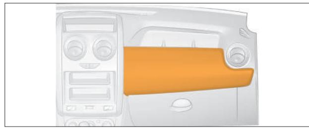
Рис. 2.6.2. Зона размещения фронтальной подушки безопасности переднего пассажира (в вариантом исполнении)
