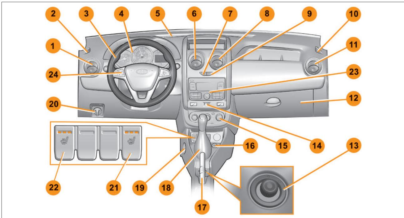
Рис. 3.1.2. Панель приборов в исполнении «Норма»
