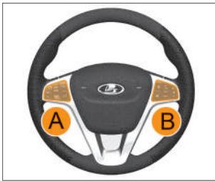
Рис. 3.4.3. Дополнительные блоки управления (в вариантом исполнении)
