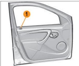
Рис. 1.3.2. Блокировка/разблокировка замков дверей изнутри (в вариантом исполнении)
