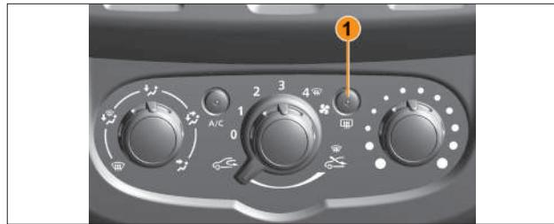
Рис. 3.11.4. Выключатель обогрева
