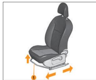
Рис. 2.1.1. Регулировка переднего сиденья
