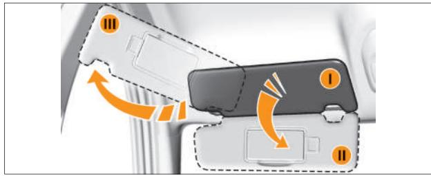
Рис. 4.3.1. Положения солнцезащитного козырька (в вариантом исполнении)
