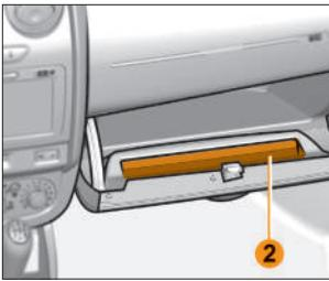
Рис. 4.5.2. Отделение в крышке вещевого ящика
