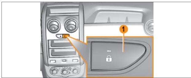
Рис. 1.3.3. Кнопка центральной блокировки/разблокировки замков дверей (в вариантом исполнении)
