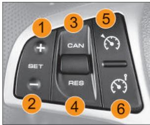
Рис. 5.11.1. Клавиши управления системами «Круиз-контроль» и «Ограничитель скорости» (в вариантом исполнении)
