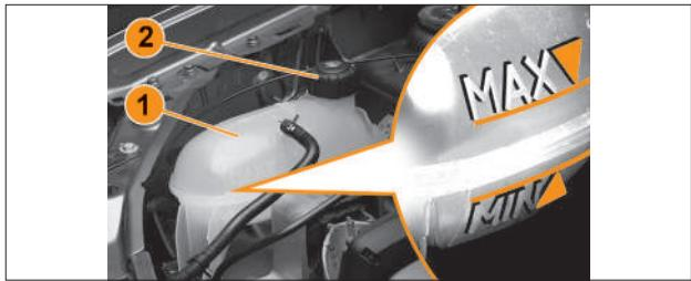
Рис. 6.4.1. Бачок системы охлаждения двигателя
