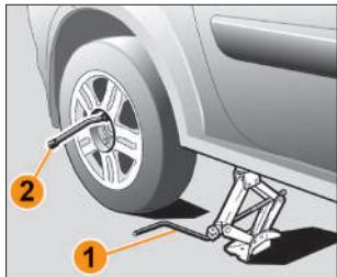
Рис. 6.9.3. Снятие колеса
