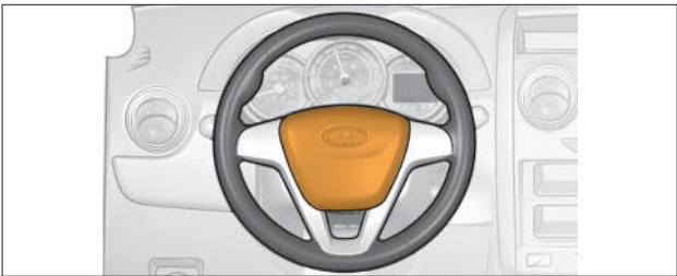
Рис. 2.6.1. Зона размещения фронтальной подушки безопасности водителя
