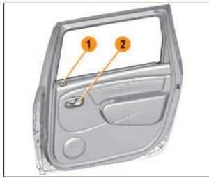
Рис. 1.4.3. Открытие задних дверей изнутри
