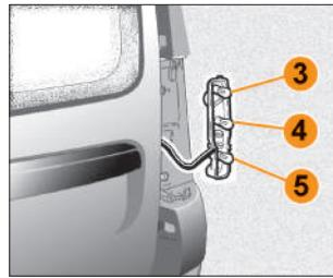
Рис. 6.13.5. Лампы заднего фонаря
