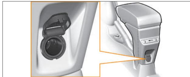
Рис. 4.4.2. Розетка 12 В для пассажиров второго ряда (в вариантом исполнении)
