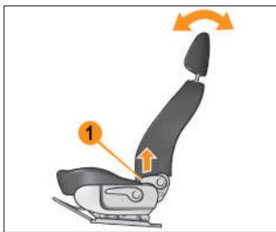
Рис. 2.1.2. Регулировка спинки переднего сиденья
