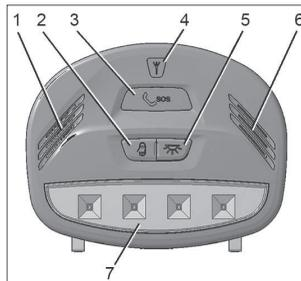
На Вашем автомобиле устанавливается блок освещения салона с функцией «ЭРА-ГЛОНАСС» (рис. 18).
