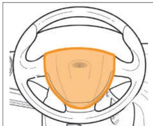
Рис. 14а. Зона размещения фронтальной подушки безопасности водителя
