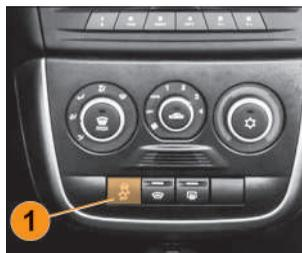
Рис. 41б. Выключатель «ESC OFF» (в варианном исполнении)
