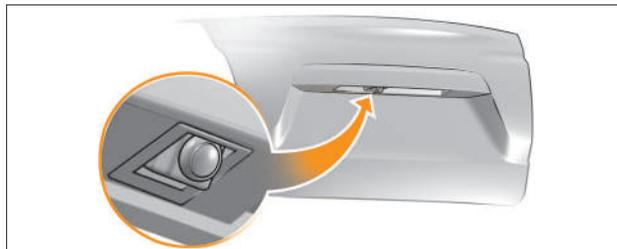
**Рис. 436. Камера заднего вида
