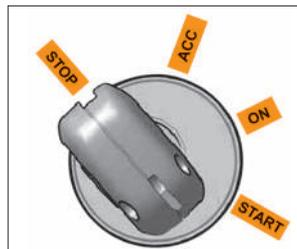
**Рис. 35а. Выключатель зажигания**
