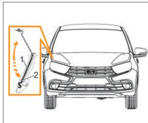
Рис. 24. Открывание капота
