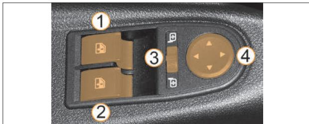
**Рис. 6в. Модуль двери водителя
