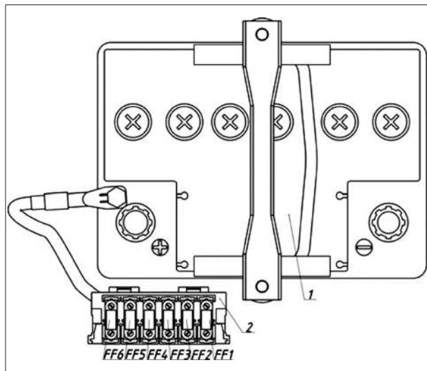
Рис. 55. Блок предохранителей
