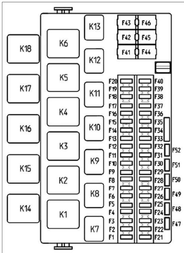
Рис. 54. Монтажный блок
