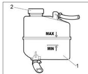
Рис. 45. Расширительный бачок
