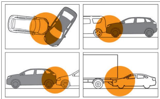
**Рис. 15в. Примеры ситуаций с возможным несрабатыванием подушек безопасности водителя и переднего пассажира**
