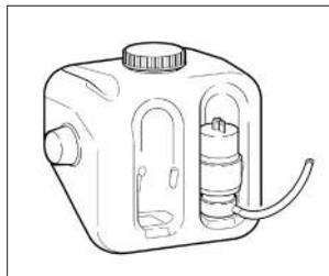
Рис. 47. Бачок стеклоомывателя
