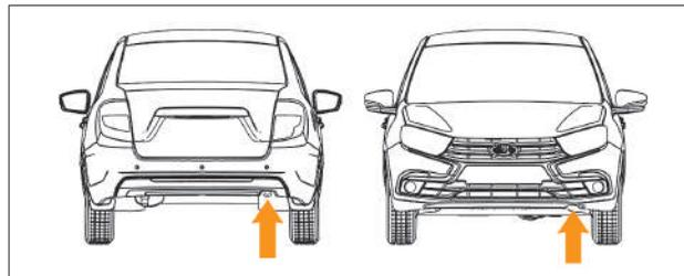
Рис. 42. Расположение буксирных проушин
