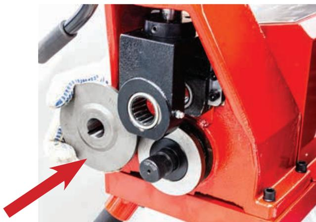
4. снять нижний вал, потянув его на себя:
