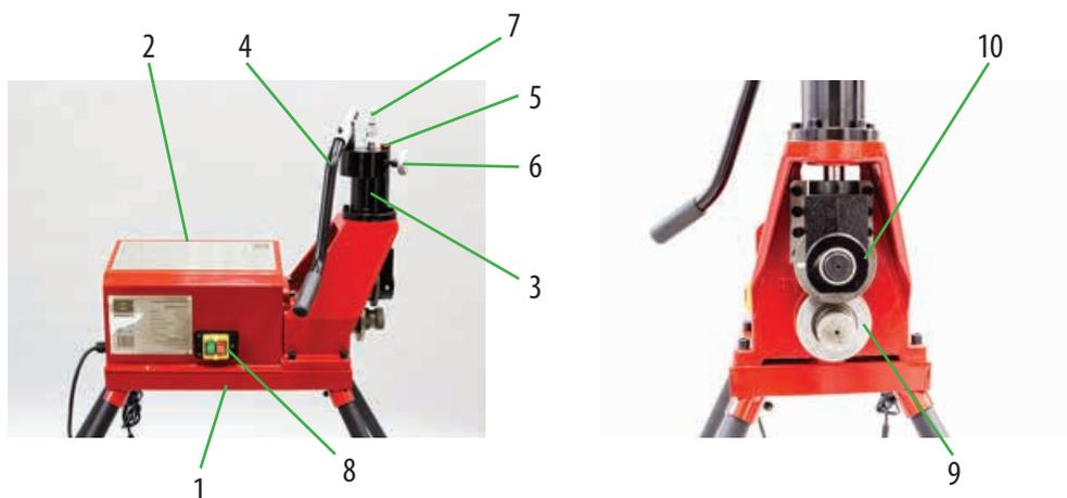
1 – станина, 2 – электрический привод, 3 – гидравлический пресс, 4 – рычаг пресса, 5 – сапун, 6 – возвратный клапан, 7 – ручка регулировки глубины желобка, 8 – кнопки включения/выключения, 9 – ведущий вал, 10 – накаточный вал.
