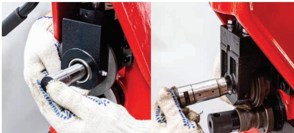
3. снять ролик:
