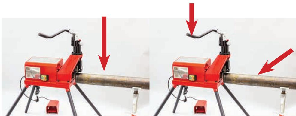
*Рис. 6 Нажмите на трубу, когда силовой привод работает в режиме FOR*
