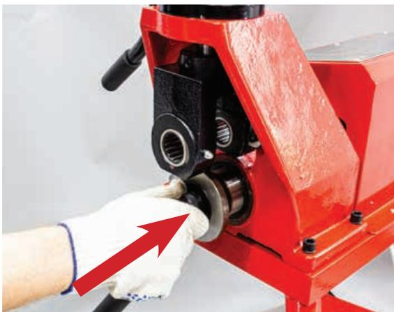
2. придерживая ролик, вставьте верхний вал в отверстие:
