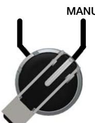
Die Betriebsart **MANU** ist nur zugänglich, wenn der Schalter entriegelt ist. Er ermöglicht den Zugriff auf eine vorübergehende Steuerung des Stellantriebs
