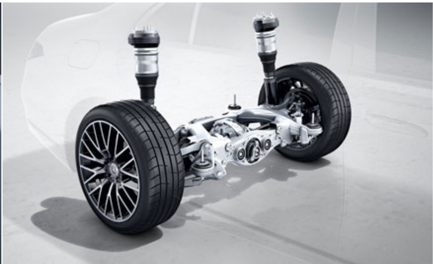
201 – Hinterachslenkung mit Einstellung des Lenkeinschlags auf 4,5°
