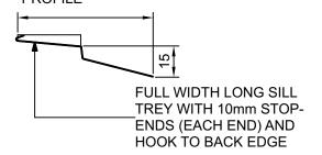
**FULL WIDTH LONG** SILL TRAY POSITIONS **UNDER MULLIONS** AND JAMBS - LAP UNDER JAMB PACKER AGAINST TRIMMING **STUDS**
