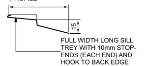
**FULL WIDTH LONG** SILL TRAY POSITIONED UNDER MULLIONS AND JAMBS - LAP UNDER JAMB PACKER AGAINST TRIMMING STUDS
