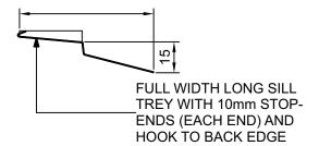
**FULL WIDTH LONG** SILL TRAY POSITIONS **UNDER MULLIONS** AND JAMBS - LAP UNDER JAMB PACKER AGAINST TRIMMING STUDS
