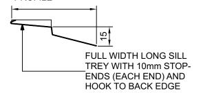
FULL WIDHT LONG SILL TRAY POSITIONS **UNDER MULLIONS** AND JAMBS - LAP UNDER JAMB PACKER AGAINST TRIMMING STUDS
