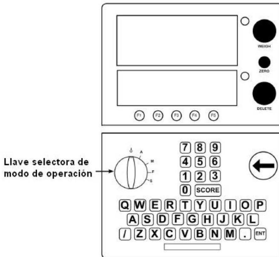
Debe asegurarse que la configuración del Bluetooth de la balanza es correcta. Para esto, colocamos la llave selectora en **S** (Setup) y nos movemos con **F1** y **F2** hasta el punto “**5. COMMUNICATIONS**” y presionamos **F5**.
