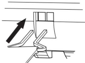
**OPMERKING:** als u het deactiveringsclipje niet meer hebt, kan de clip worden nagemaakt door een dunne, metalen papierclip in een U-vorm te buigen.
