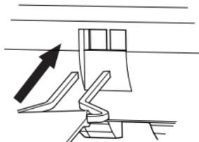
**REMARQUE:** si la languette de désactivation est égarée, elle peut être reproduite en ouvrant un trombone métallique fin en forme de U.
