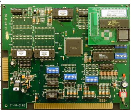
JUMPER 12 POSITION: UNDERNEATH DIP SWITCH 1, CLOSE TO EDGE. MARK J12.
