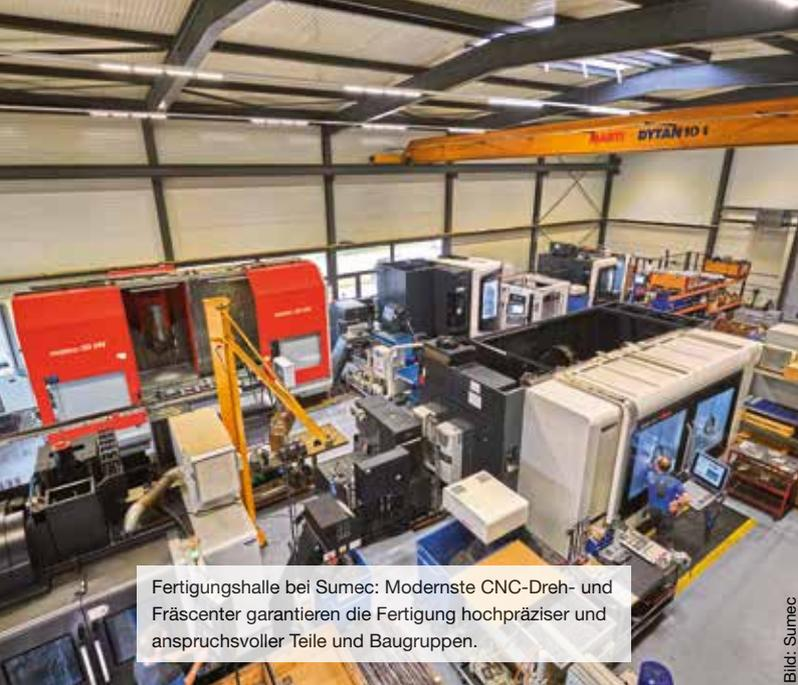
Fertigungshalle bei Sumec: Modernste CNC-Dreh- und Fräscnter garantieren die Fertigung hochpräziser und anspruchsvoller Teile und Baugruppen.
